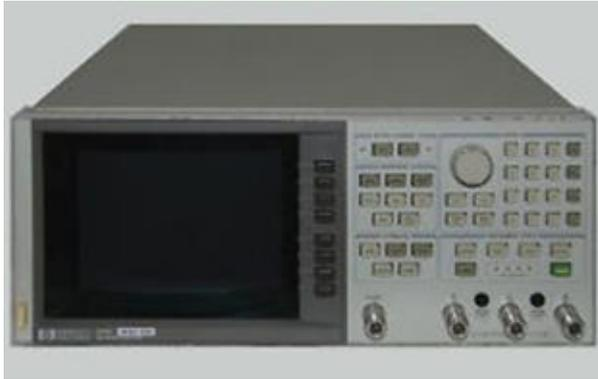
Figura 18. Panel frontal del analizador de redes vectorial (HP 8753C)
