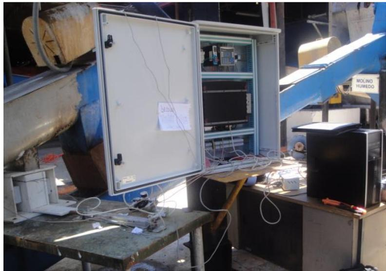
Figura 36. Sistema de medición del CH implementado en la planta de elaboración de harina de pescado de Pesquera Tierra Colorada en Paita
