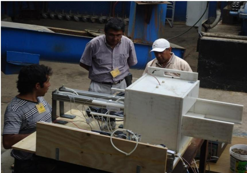
Figura 5. Sistema de medición de contenido humedad implementado en una planta procesadora de harina de pescado en Paita- Fuente: Elaboración propia.
