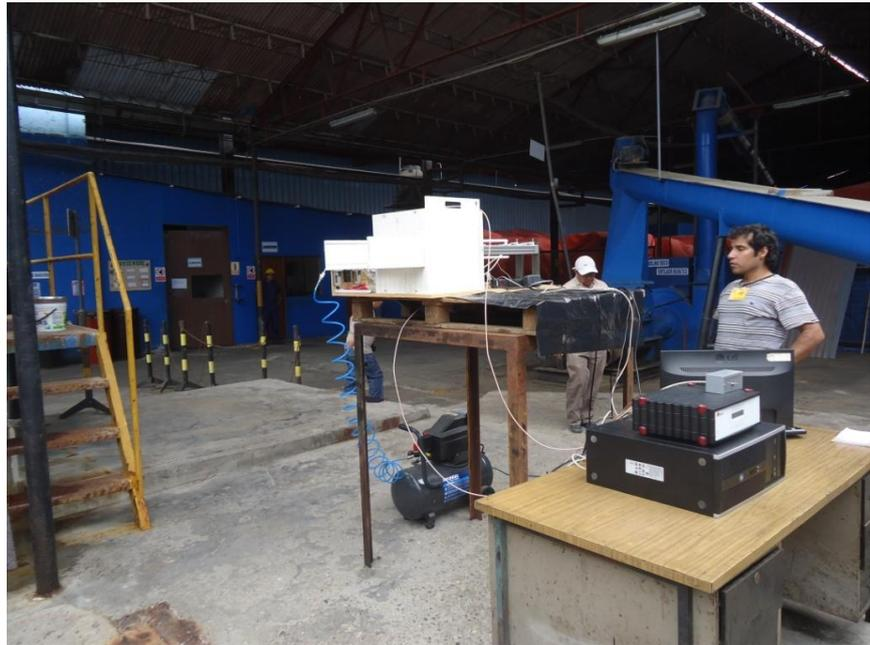
Figura 17. Sistema de medición de CH con técnica ED basado en el módulo WT aplicado en el proceso de elaboración de harina de pescado (Foto: Rodolfo Rodríguez, 2012).
