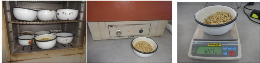
Figura 40. Muestras de granos de café secándose en un horno y pesándose en el Laboratorio de Suelos de UDEP.
