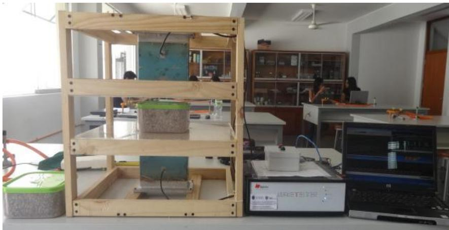
Figura 39. Aplicación de un prototipo de sistema de ED a la medición del CH en muestras de café.
