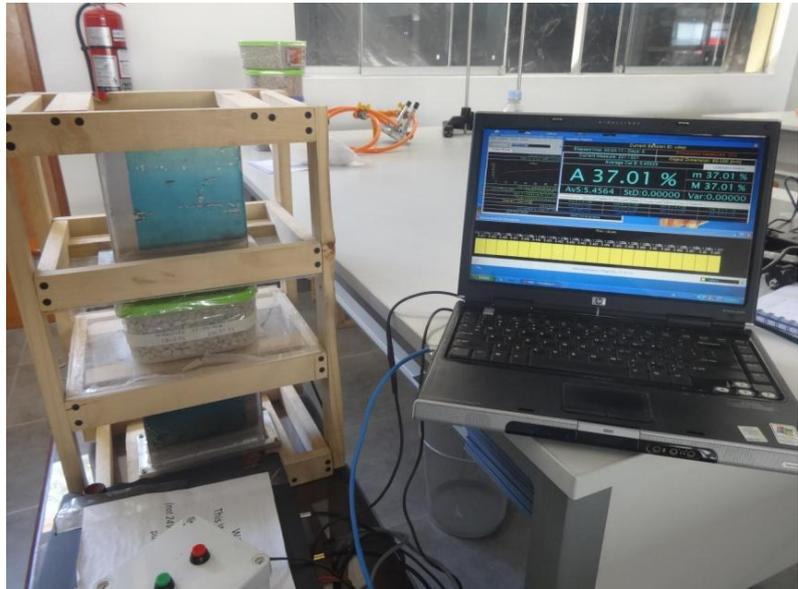
Figura 41. Determinación de la CD con el prototipo en una muestra de granos de café con CH de 37.01%
