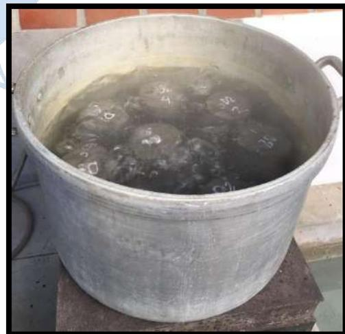
**Foto A.6.** Ensayo de absorción
