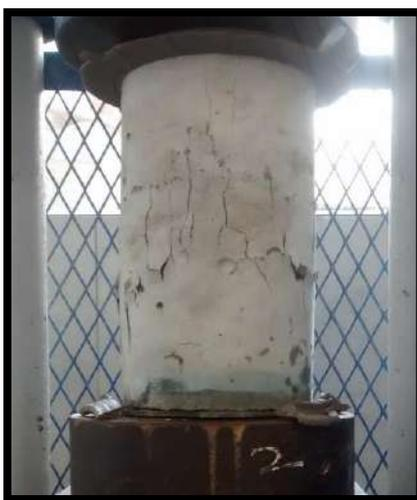
**Figura 9.** Forma típica de falla del concreto a compresión
