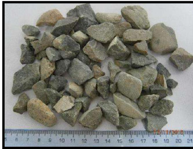
**Figura 12.** Agregado grueso de la cantera Sojo
