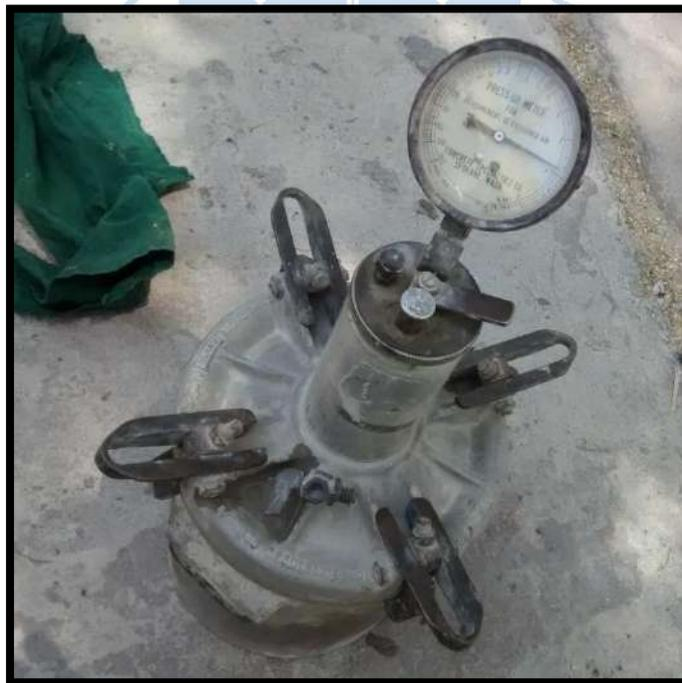
**Foto A.3.** Contenido de aire del concreto en estado fresco
