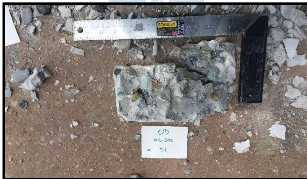
**Foto A.7.** Probeta con 5% de RCA de reemplazo
