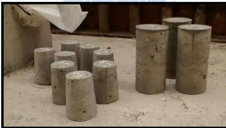
**Figura 21.** Mini-probetas y probetas cilíndricas elaboradas en el LEMC
