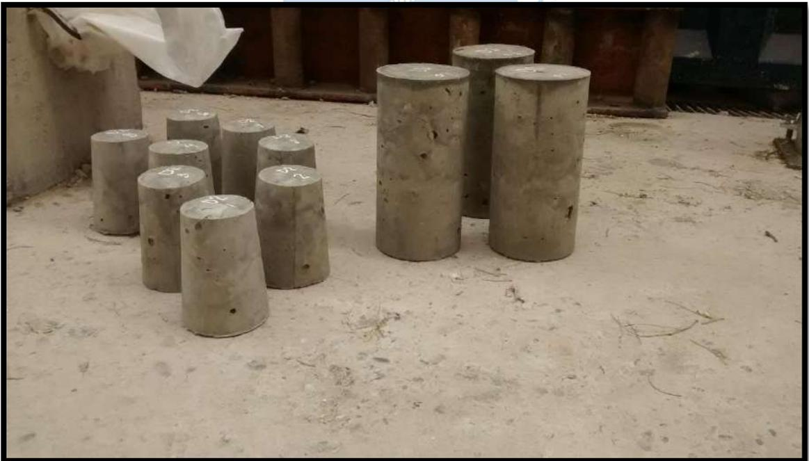
**Foto A.5.** Desencofrado de probetas
