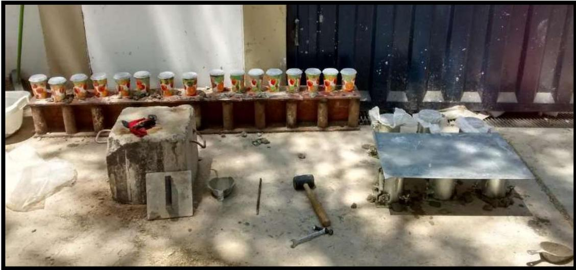
**Foto A.4.** Elaboración de probetas de concreto
