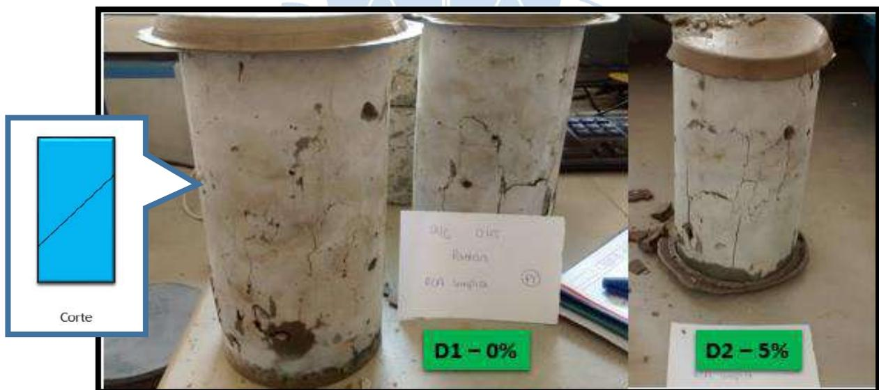
**Figura 31.** Patrones de falla de las probetas cilíndricas para 0% y 5% de reemplazo
