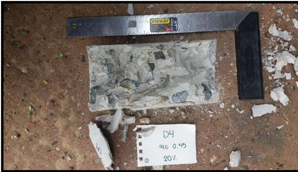
**Foto A.8.** Probeta con 20% de RCA de reemplazo
