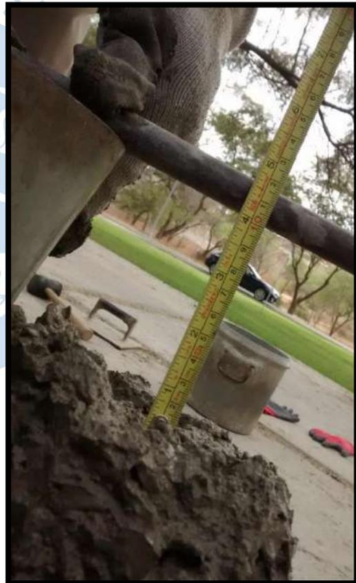
**Foto A.1.** Ensayo de Consistencia del concreto con el Cono de Abrams
