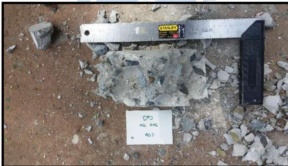
**Foto A.9.** Probeta con 40% de RCA de reemplazo
