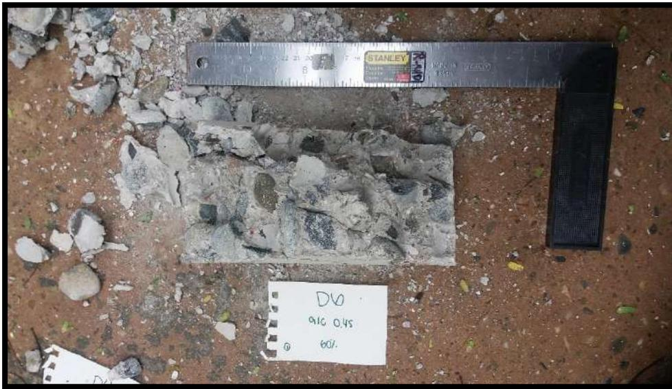
**Foto A.10.** Probeta con 60% de RCA de reemplazo
