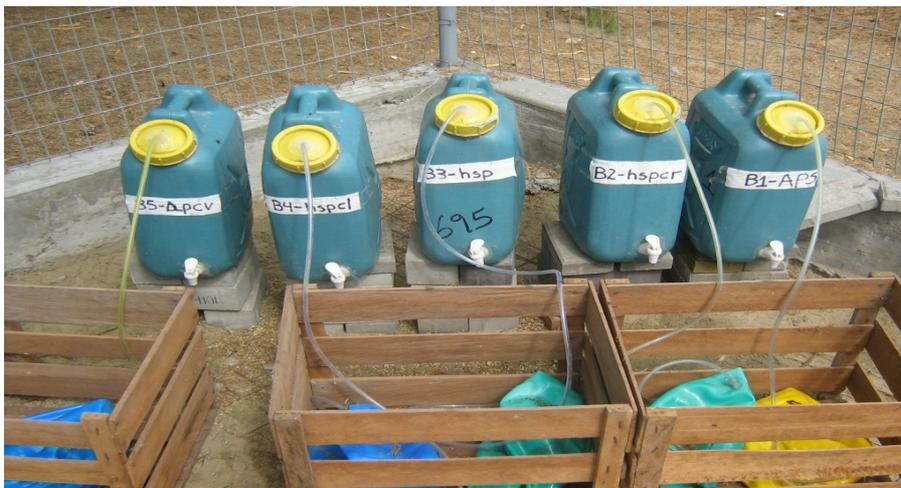
Foto c3.1: Instalación de los biodigestores. Se observa que las pelotas de playa reemplazan a las probetas.
