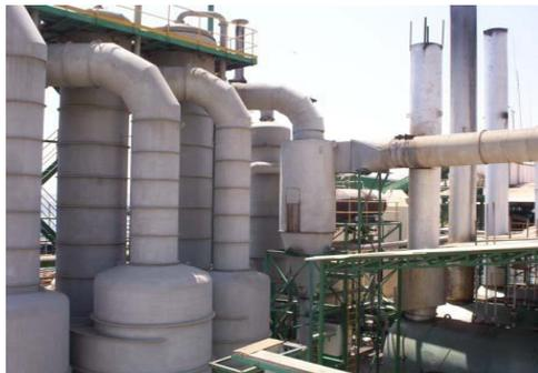
Foto 2.1: Planta evaporadora de película descendente<sup>193</sup>
