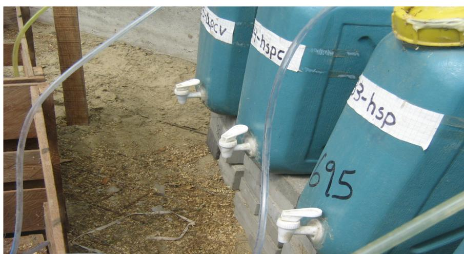
Foto c3.3: Las válvulas instaladas en cada biodigestor, permiten la toma de muestras del contenido de los reactores para medir su pH.
