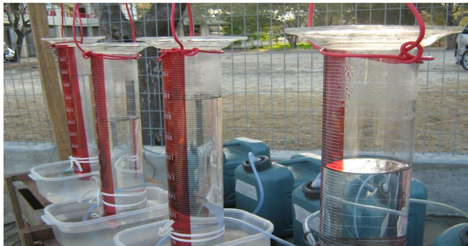
Foto c2.2: Biogás recogido en las probetas. Se observa el volumen de biogás producido en cada biodigestor.
