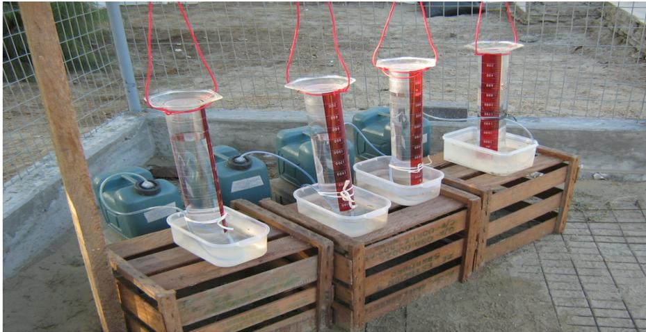
Foto c2.1: Instalación de los biodigestores. Se observa que las mangueras de los reactores están insertadas en las probetas y están sujetas externamente con ligas.
