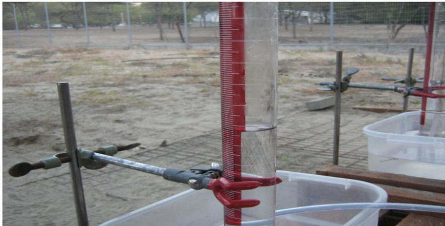
Foto c1.2: Los soportes universales y abrazaderas sostienen las probetas llenas de agua. Durante el experimento ocurre el desplazamiento del contenido de agua debido a la generación del biogás.
