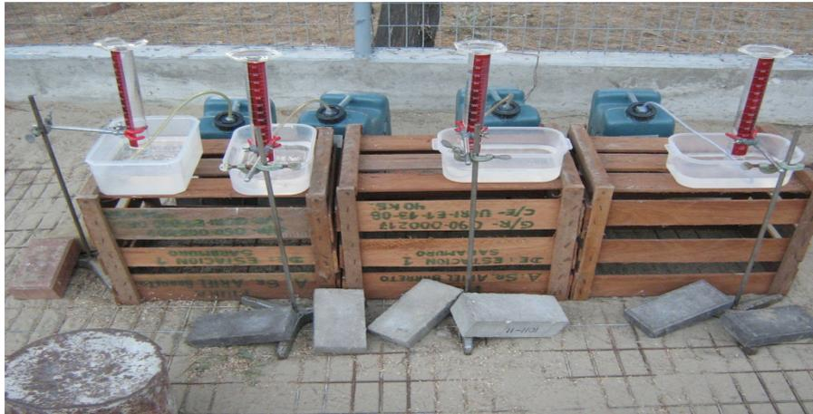
Foto c1.1: Instalación de los biodigestores. Se observa que las mangueras de los reactores están insertadas en las probetas para la recolección del biogás generado.
