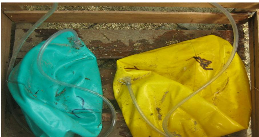
Foto c3.2: Las pelotas de playa reciben temporalmente el biogás generado, a través de mangueras.
