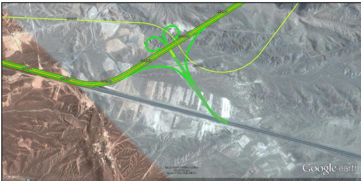
**Fig. 3.15: Esquema del primer intercambio vial del tramo 02 ubicado en el Km 3+700, del tipo diamante en las cercanías de la Plataforma de Actividad Logística (PAL)**
