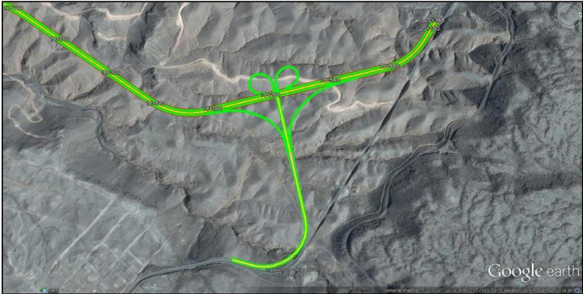
**Fig. 3.17: Esquema del segundo intercambio vial del tramo 02 ubicado en el Km 19+250, del tipo diamante en las proximidades de la intersección vía nacional PE 34A**
