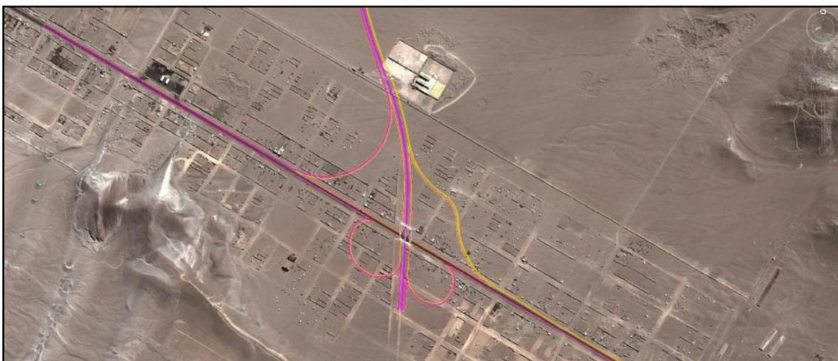
**Fig. 3.13: Esquema del intercambio vial del tramo 01: Carretera Panamericana Sur (PE-1S) con el eje La Joya – Yura, del tipo diamante**
