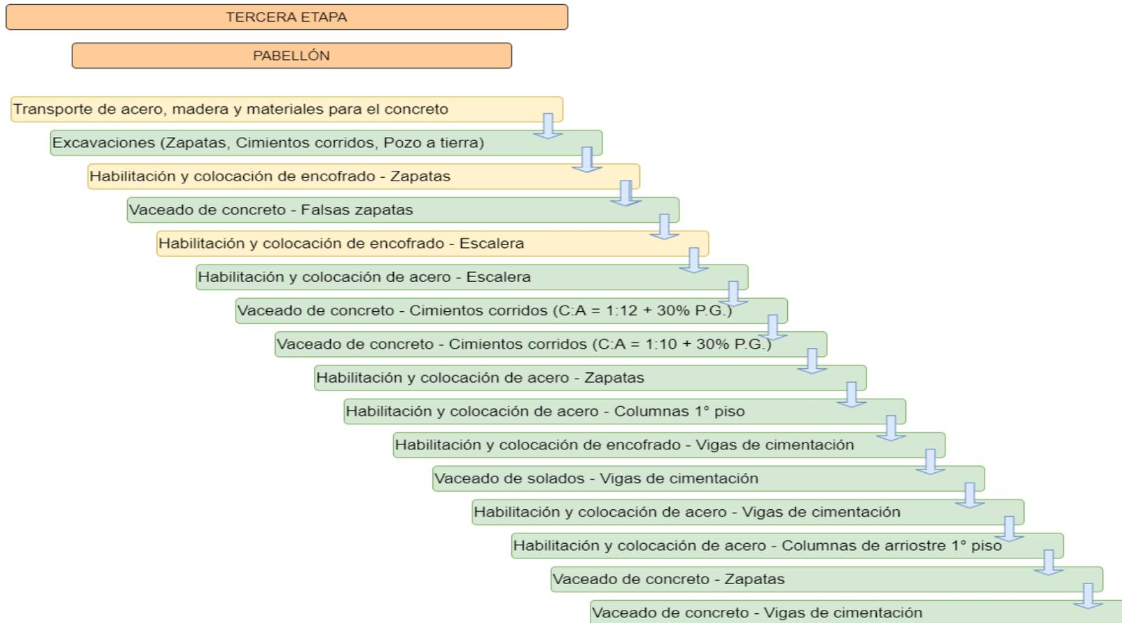
**Figura 11:** Diagrama de flujo de la tercera etapa de proceso constructivo (construcción del pabellón).
