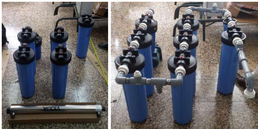
Figura 22. Fotografías del sistema de filtros
