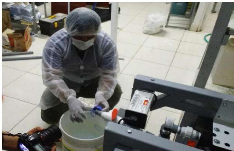
Figura 39. Toma de muestras a la salida del prototipo
