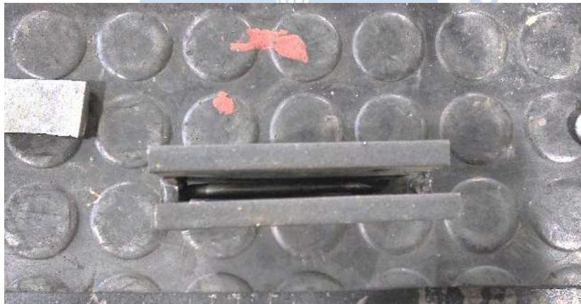
**Figura 15.** Punzón utilizado en el ensayo de doblez inicial
