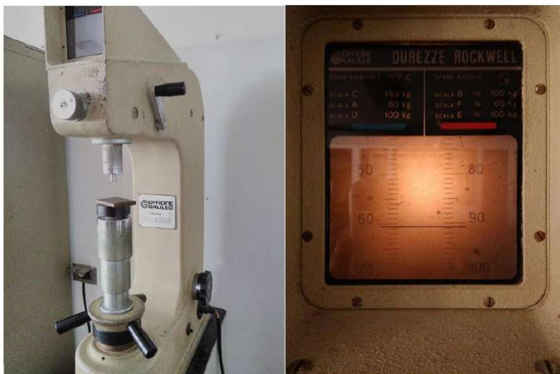
Hay distintos tipos de ensayo de dureza: Brinell, Vickers, Microdureza de Knopp y Rockwell. Dependiendo de cuál de estos se use, se determina la carga y el tipo de penetrador utilizado; también influye si el material es considerado blando o duro. En este caso, se realizó un ensayo Rockwell B, en el cual se aplica una carga de 100 kg con una esfera de acero de diámetro 1/16 in (Smith & Hashemi, 2006).
