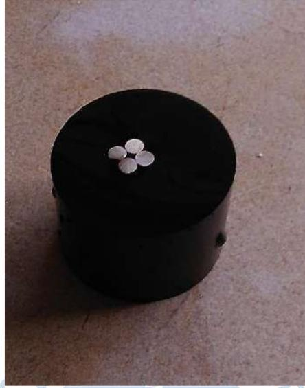
El ensayo de dureza consiste en aplicar, con un penetrador, una carga conocida y controlada, en dirección perpendicular a la superficie del elemento. Luego, la relación entre la profundidad de la hendidura en la superficie del elemento y las dimensiones del penetrador proporciona una medida de la dureza del material (Kalpakjian & Schmid, 2010). Dependiendo del banco de ensayo, esta medida se obtiene directamente de un monitor, como el de la Figura 11, o se calcula de forma empírica.
