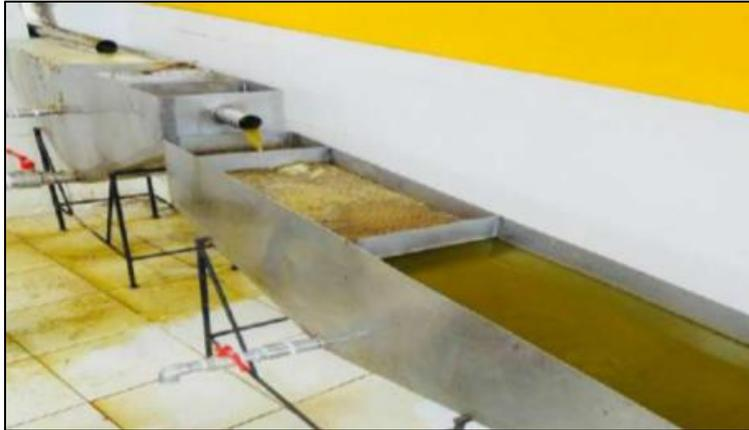
**Figura 53.** Filtración y decantación en el módulo de Taylín
