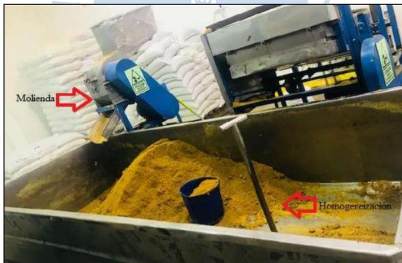
**Figura 61.** Molienda y homogeneización
