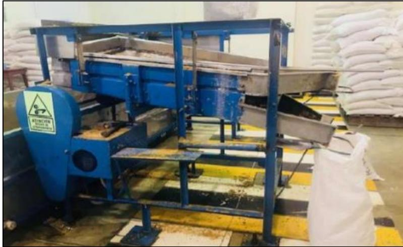
**Figura 62.** Tamizador de panela
