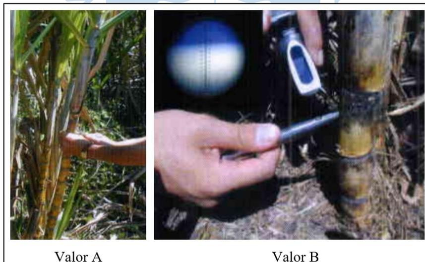
**Figura 20.** Uso del refractómetro (valor A y valor B)
