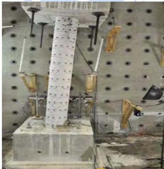
**Figura 24.** Configuración del ensayo pseudodinámico de una columna.
