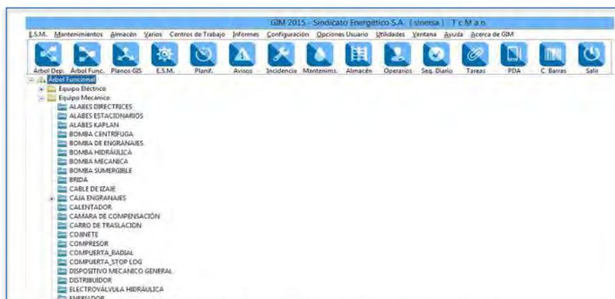
**Figura 5.17. Árbol funcional del equipo mecánico.**
