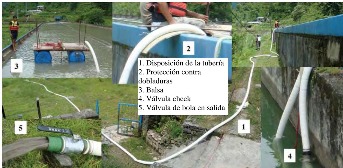
**Figura 103.** Instalación experimental en la cámara de sedimentación de la pequeña central hidroeléctrica Sunkoshi.
