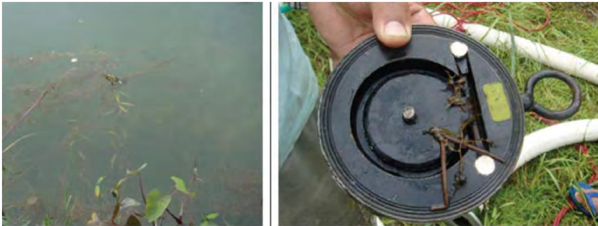
**Figura 107.** Crecimiento denso de maleza en el embalse y el escombro que atrapa en la placa de la válvula.
