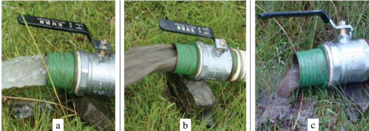
**Figura 106.** Flujo de salida a) después del cebado, b) flujo normal y c) flujo obstruido.
