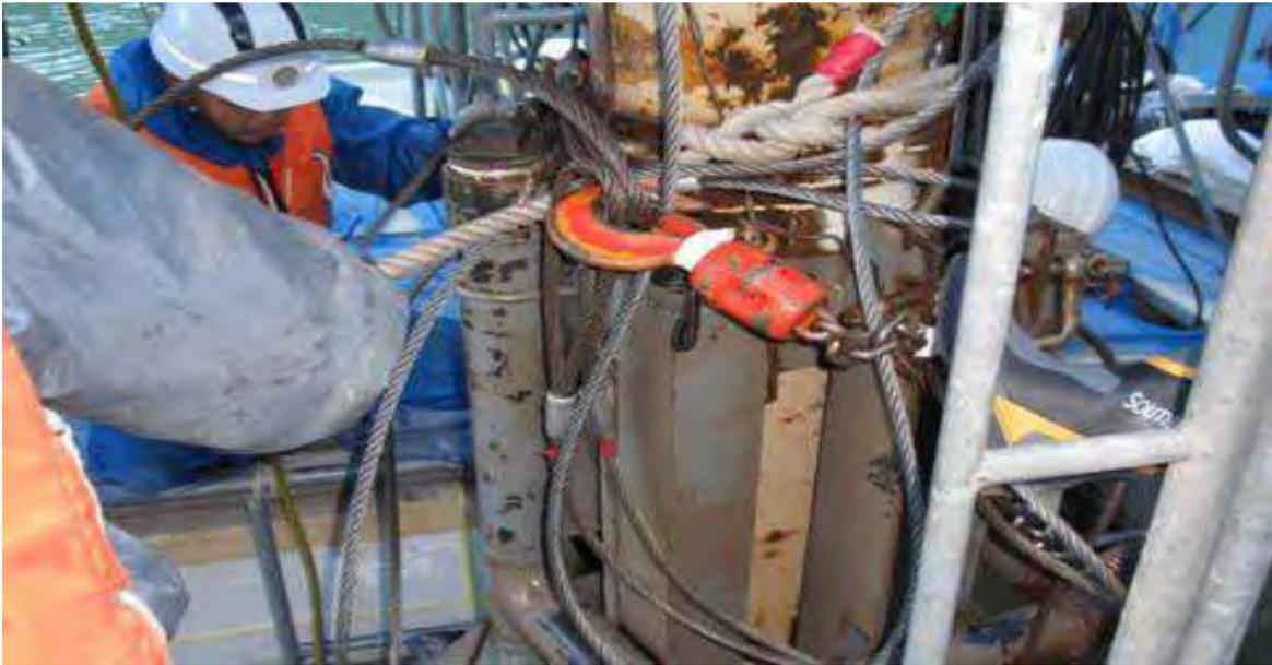
**Figura 83.** La cabeza de succión con sistema de corte
