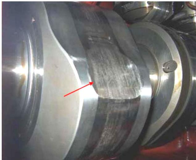
**Figura 1. Imagen de la leva dañada.**
