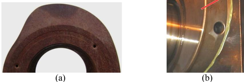
**Figura 3.3 (a). Vista de perfil de la mitad superior de la leva extraída. (b). Colocación de la plantilla recubierta con resina sobre una leva del eje.**
