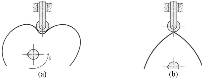
Figura 2.17. Problemas por valores incorrectos del radio de curvatura.
