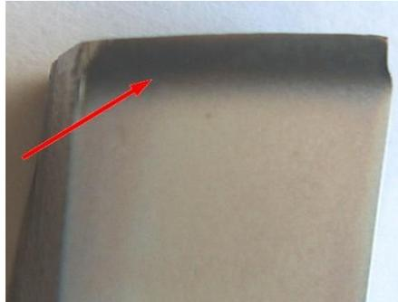
Figura 3.1. **Muestra de la capa superficial de cementación de la leva en estudio.**
