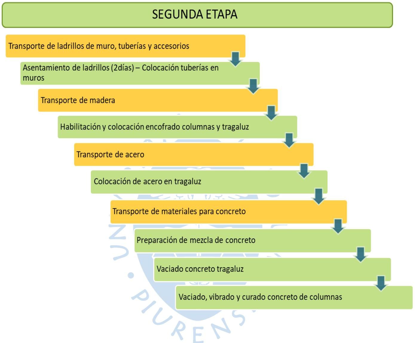
**Figura 7. Diagrama de flujo correspondiente a la segunda etapa del proceso constructivo**
