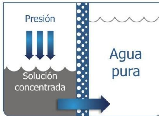
**Figura 13** Esquema del principio de ósmosis inversa
