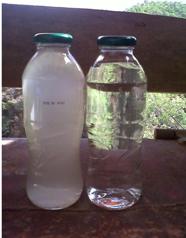
**Figura 27** Fotos de la muestra antes y después de la ultrafiltración
