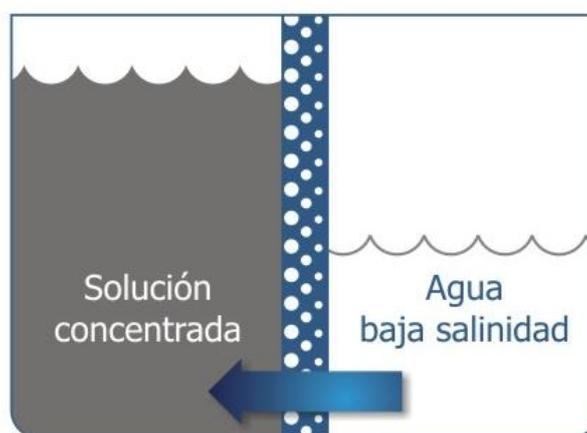
**Figura 12** Esquema del principio de ósmosis
