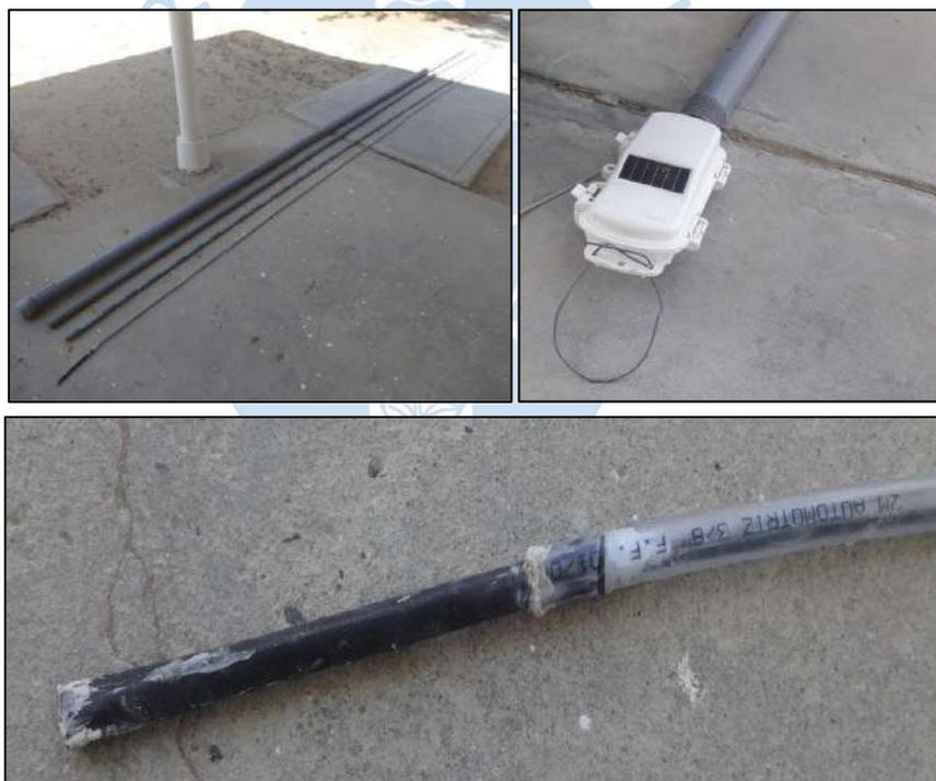
Figura. Ensamblaje del cable sensor de temperatura
