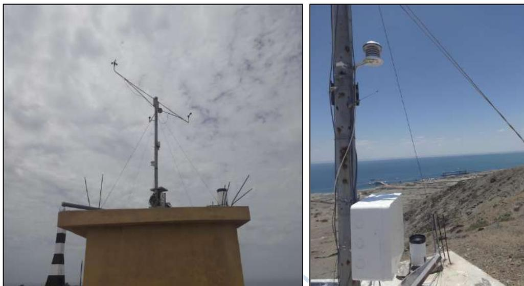
Figura1. Disposición final de los sensores y el datalogger de la estación NRG instalada en el campamento Bayóvar de Petroperú
