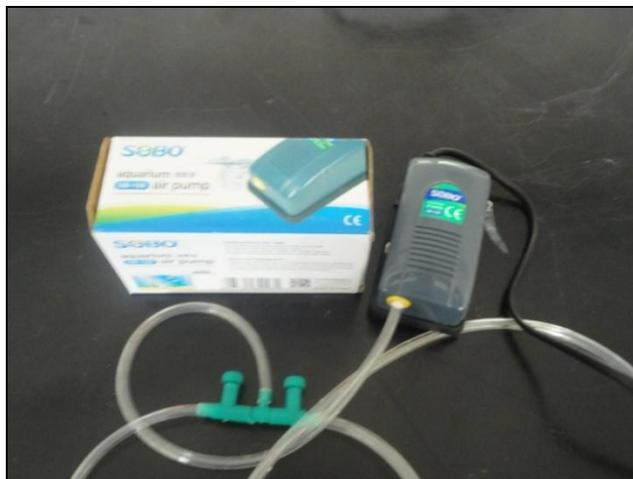
**Figura 42:** Compresor de aire para agitación de los electrolitos del anodizado
