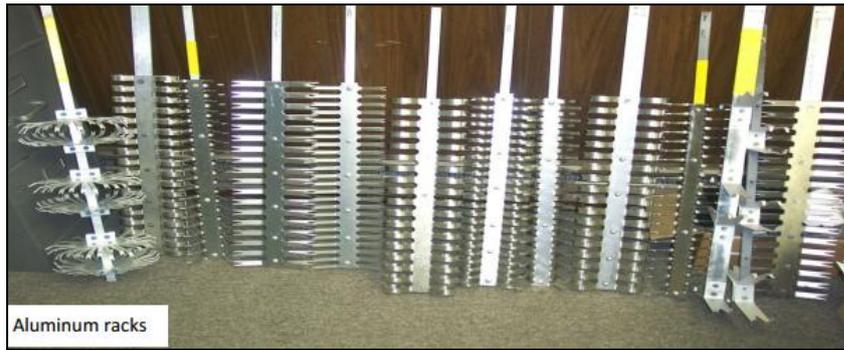
**Figura 31: Racks para el proceso de anodizado.**
