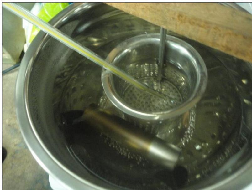
Figura 46: Tratamiento de sellado a temperatura de 90°C por treinta minutos.
