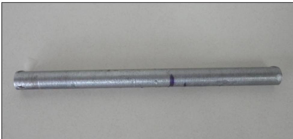
Figura 57: Probeta de acero utilizada para evaluar su resistencia a la corrosión en sistemas ICCP
