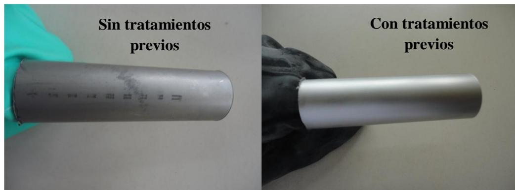
Figura 50: Probetas de titanio antes y después de recibir los tratamientos previos al anodizado.
