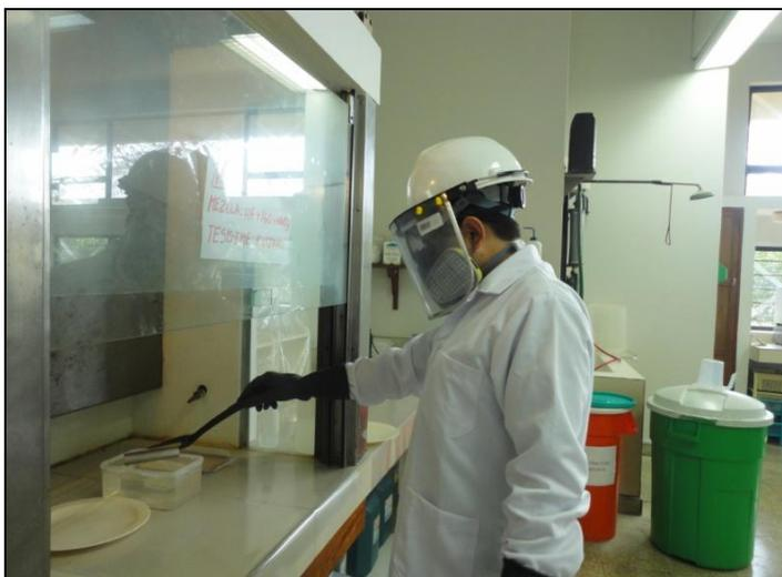
**Figura 39: Decapado por 4 minutos en campana extractora de la Udep (Lab. Química).**
