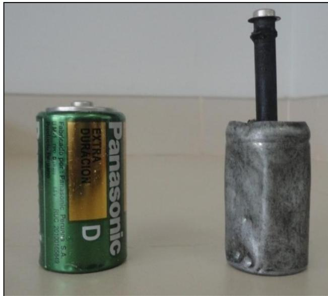
**Figura 56: Probeta de grafito utilizada para evaluar su resistencia a la corrosión en sistemas ICCP**
