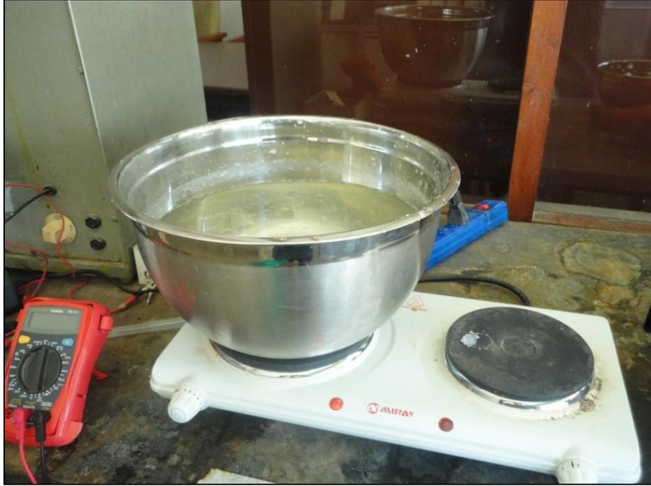
Figura 45: Celda electrolítica para anodizado con ácido bórico
