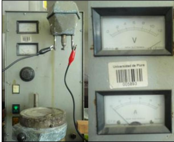
Figura 40: Equipo electrolítico para realizar el anodizado en probetas de titanio
