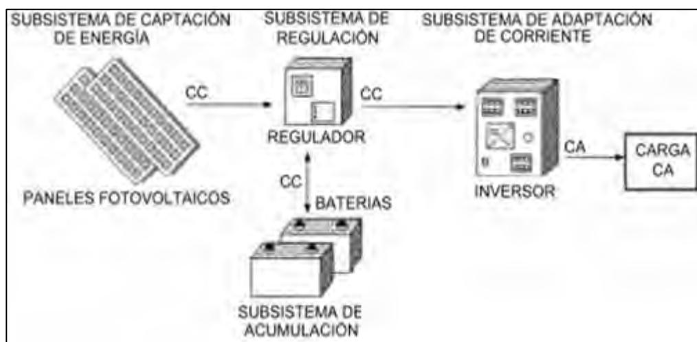
Figura 1. Distribución y secuencia del flujo de energía en un sistema fotovoltaico, desde la recepción de la energía solar por medio de “Paneles Fotovoltaicos” hasta la alimentación de dispositivos considerados como “Carga”.
