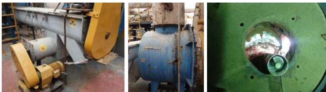
Figura 33. Tornillos sin fin para carga de material en el secador
