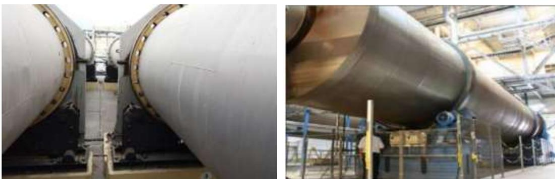
Figura 32. Sistema de accionamiento para rotación del cilindro
