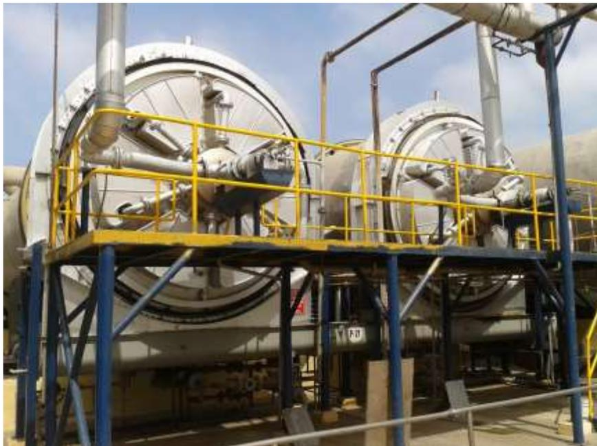
Figura 24. Secador Rota Tubo
