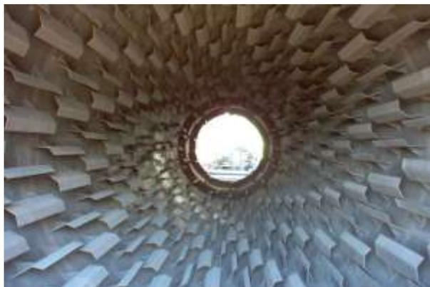
Figura 26. Interior de secador rotatorio directo
