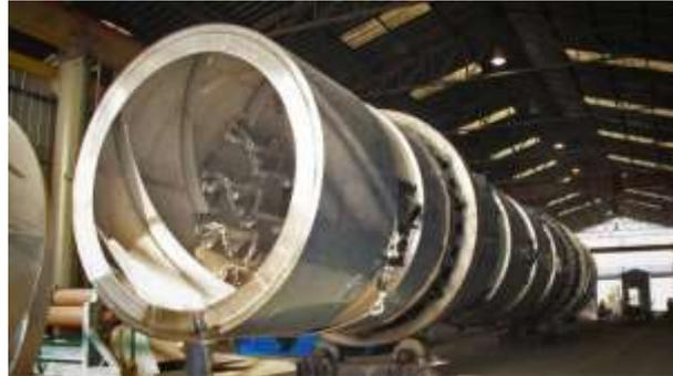
Figura 27. Secador directo de aire caliente construcción
