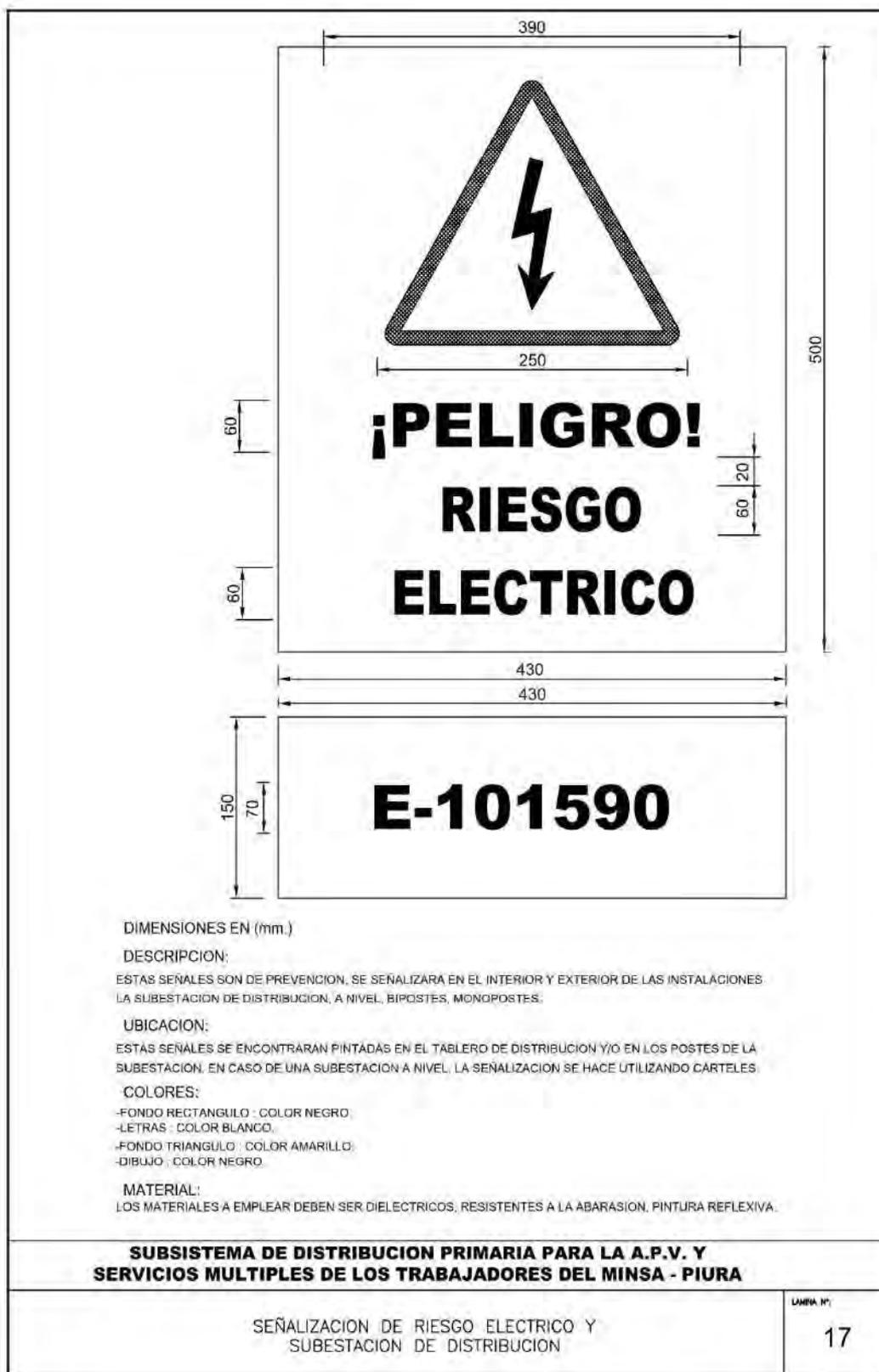
**Figura G17. Señalización de riesgo eléctrico y sub estación de distribución**
