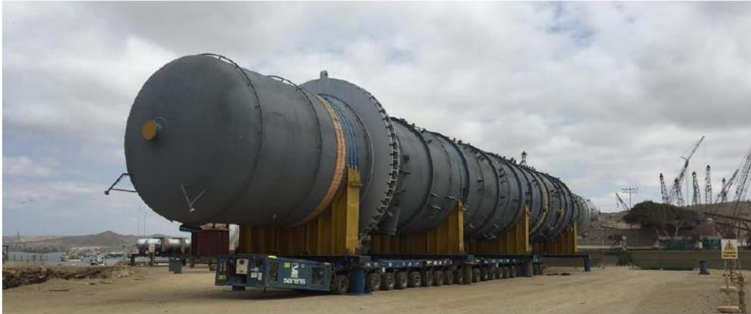
Figura 57. Columna de destilación
