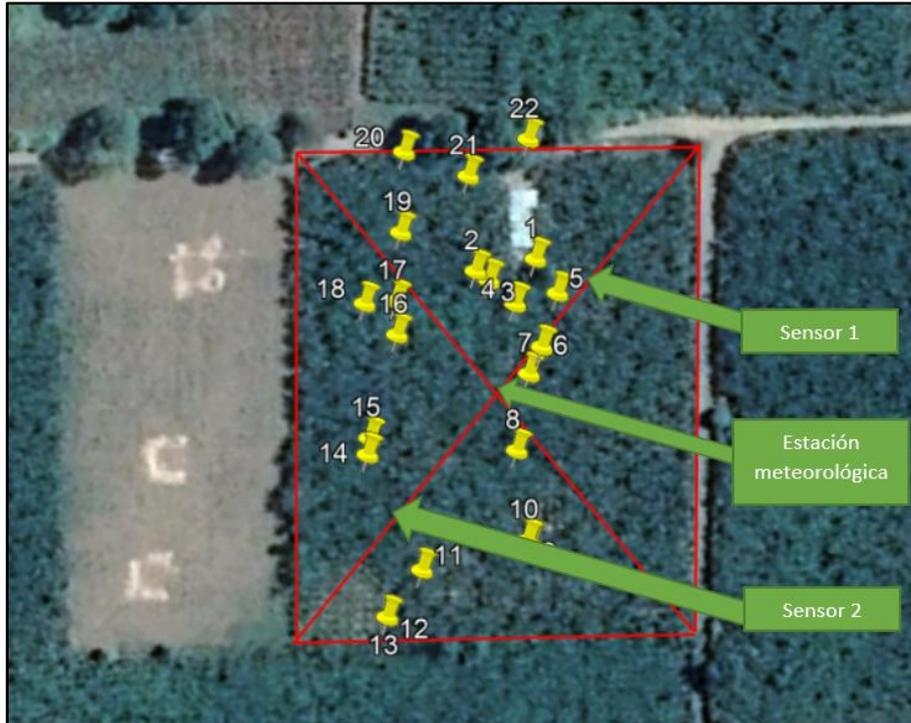
**Figura 42.** Ubicación ideal para los dos sensores y la estación meteorológica
