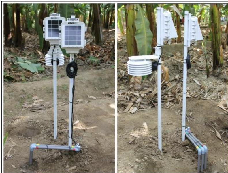
Figura 44. Sensores de temperatura y humedad
