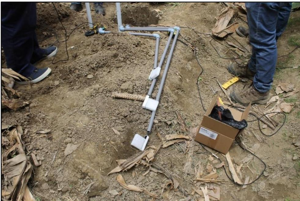
**Figura 43.** Sensores de temperatura y humedad para mediciones del suelo
