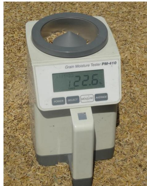
Ilustración 1 Medidor de Humedad
