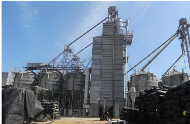
*Ilustración 5 Secadora de arroz y Silo de enfriamiento*
