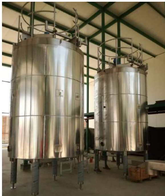
Ilustración 49. Silos de almacenamiento de licor de cacao en Norandino
