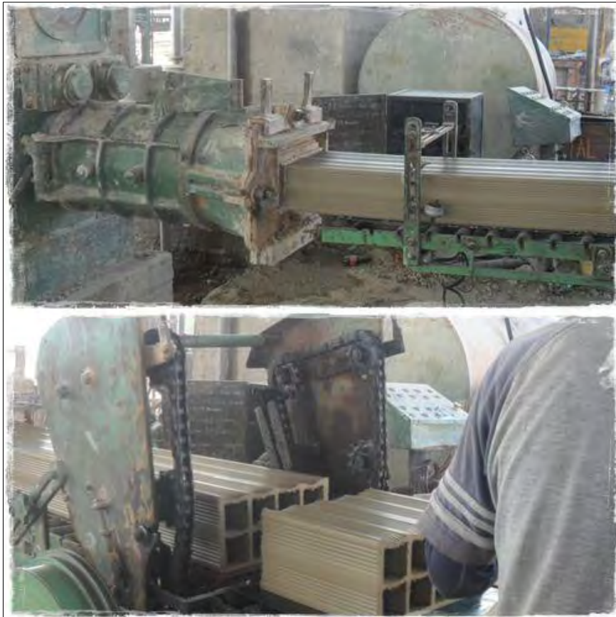
Figura 2.32: Corte de unidades crudas en ladrillera semi-industrial
