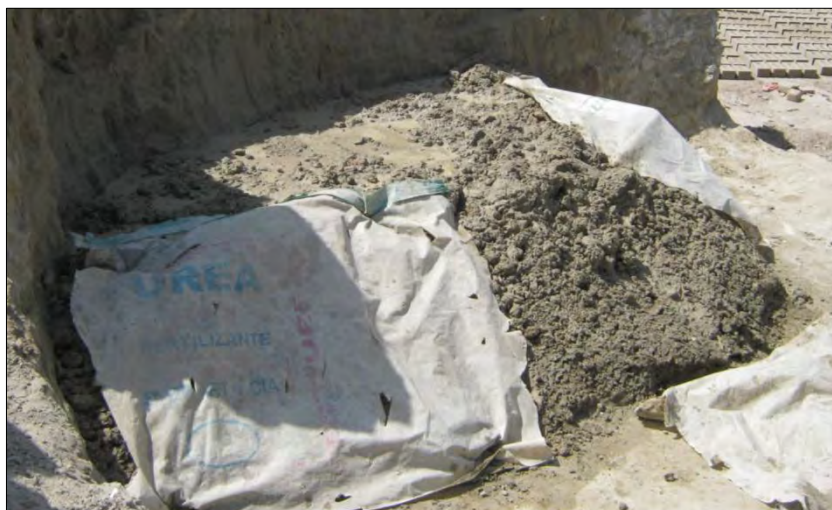
Figura 2.26: Mezcla en reposo en ladrillera artesanal de Piura
