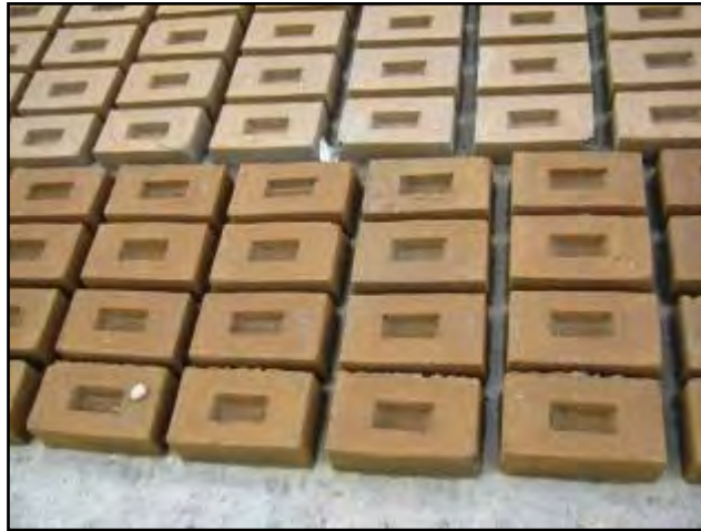
Figura 2.18: Unidades de albañilería crudas en La Unión
