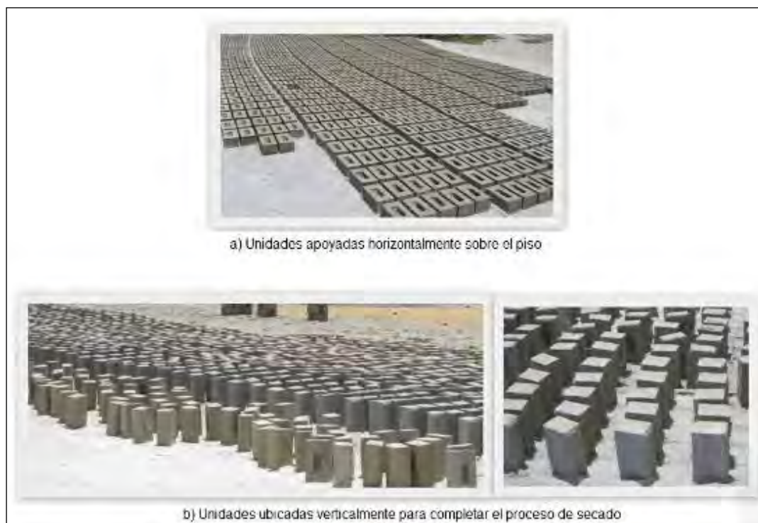
Figura 2.10: Proceso de secado de las unidades antes de la cocción
