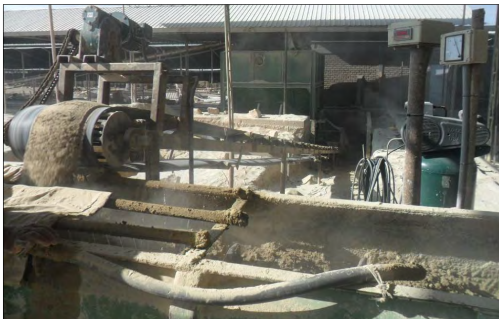
Figura 2.30: Mezcla de materia prima con agua en ladrillera semi-industrial
