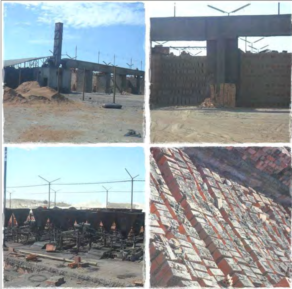
Figura 2.35: Horno tipo Hoffman abierto en ladrillera El Tallán
