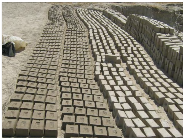
Figura 2.27: Secado de las unidades crudas en ladrillera de Piura
