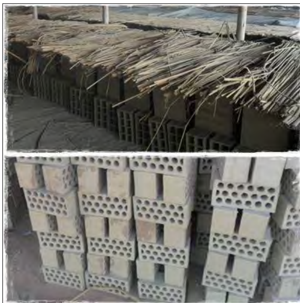
Figura 2.33: Secado de las unidades de arcilla en ladrillera El Tallán
