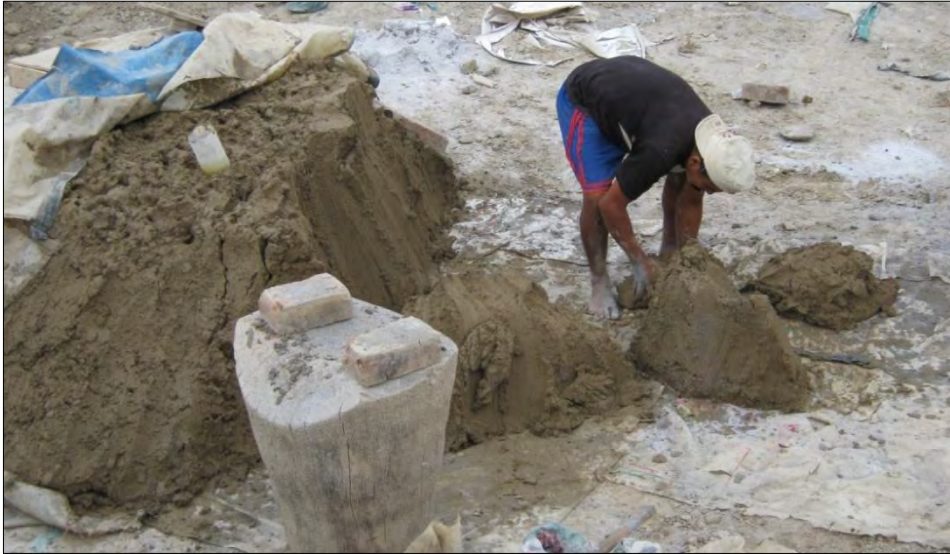
Figura 2.8: Segundo amasado de la mezcla antes de empezar el moldeo en las gaveras, después de 24 hrs de reposo en Marcavelica
