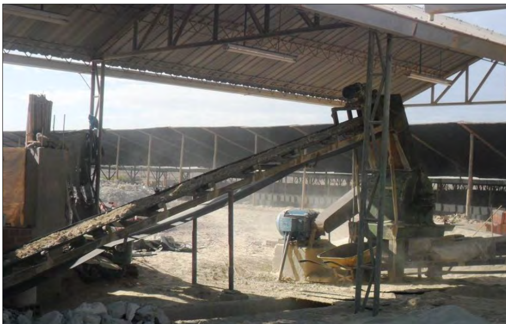
Figura 2.29: Proceso de trituración de la materia prima en ladrillera semi-industrial
