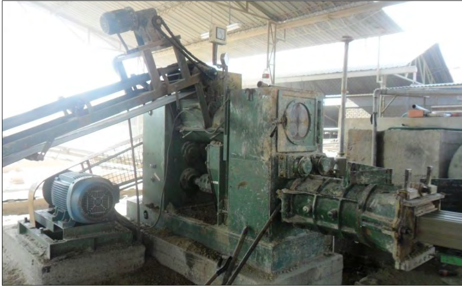
Figura 2.31: Proceso de moldeo en ladrillera semi-industrial
