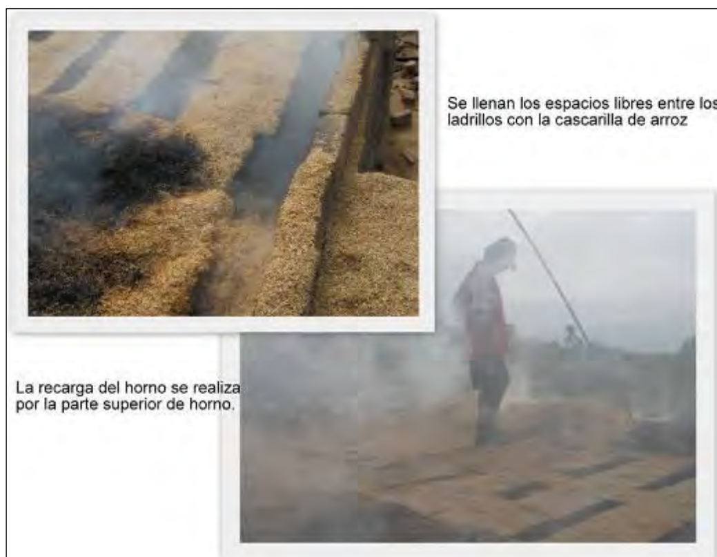
Figura 2.14: Quema de ladrillos con cascarilla de arroz en Marcavelica
