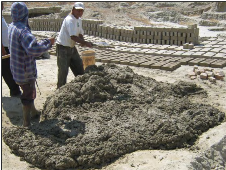
Figura 2.25: Amasado de la mezcla en ladrillera artesanal de Piura
