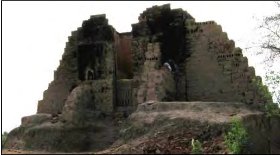
Figura 2.15: Horno para ladrillos usando leña como combustible en Cerro Mocho
