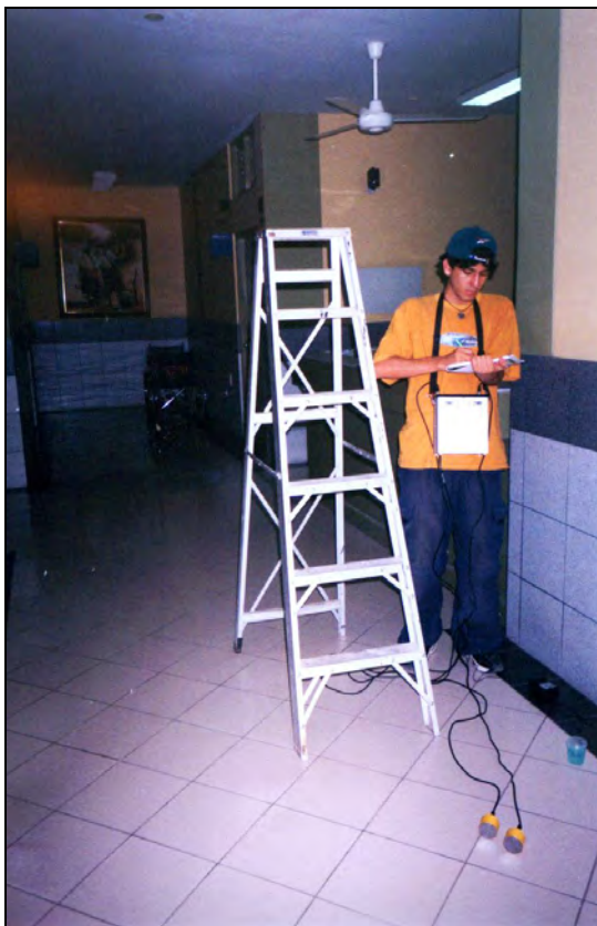
Fotografía 7.6: Toma de datos con el Pulso Ultrasonido en la CSM (Zona de Clínica). Durante el trabajo, realizando anotaciones.
