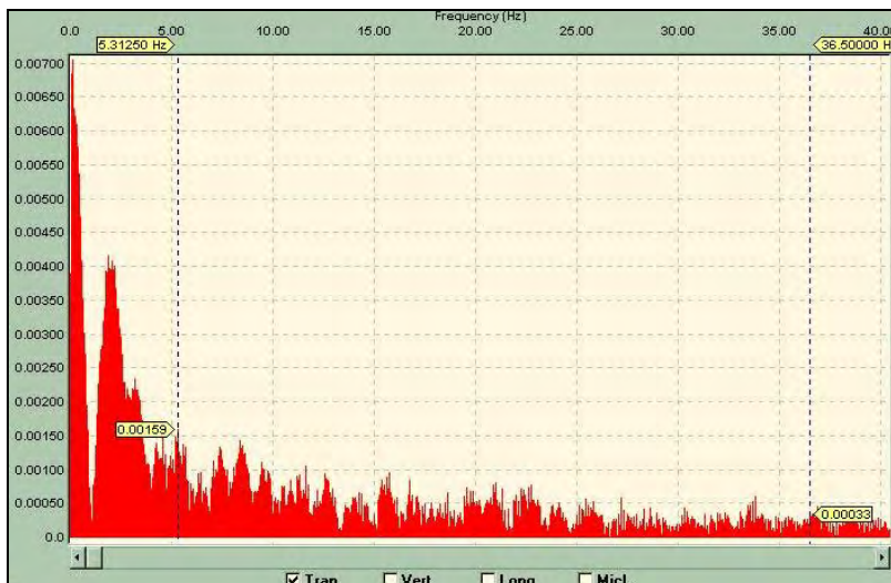
Figura 7.7: Espectro de Fourier de aceleración medida en ensayo E1, en la dirección transversal al sismógrafo. La frecuencia = 5.31 Hz.
