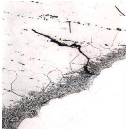
Figura 2.25 Microfisura extendiéndose entre las juntas de grano. Fuente: TWI 51
