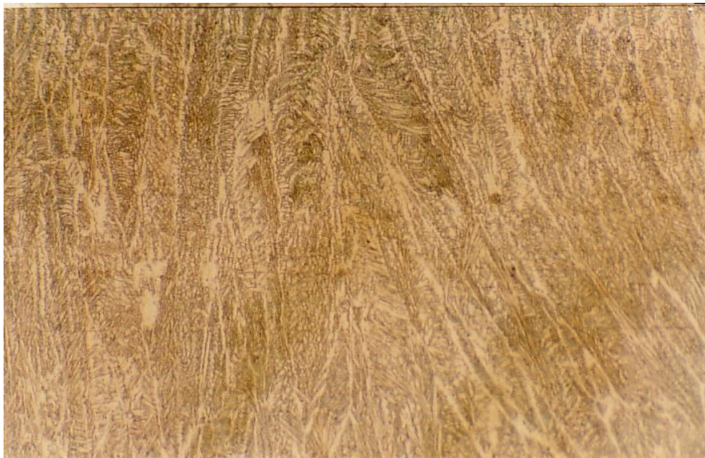
Figura 4.11 Fenómeno de crecimiento epitaxial con granos columnares y alargados. Aumento 200x.
