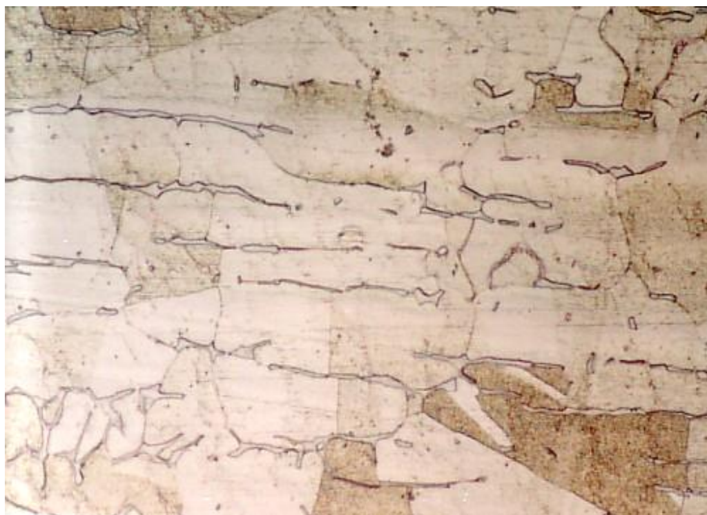
Figura 4.24 Ferrita acicular alargada en la ZAT. También se observa la presencia de glóbulos de ferrita entre los granos. Aumento 1000X.
