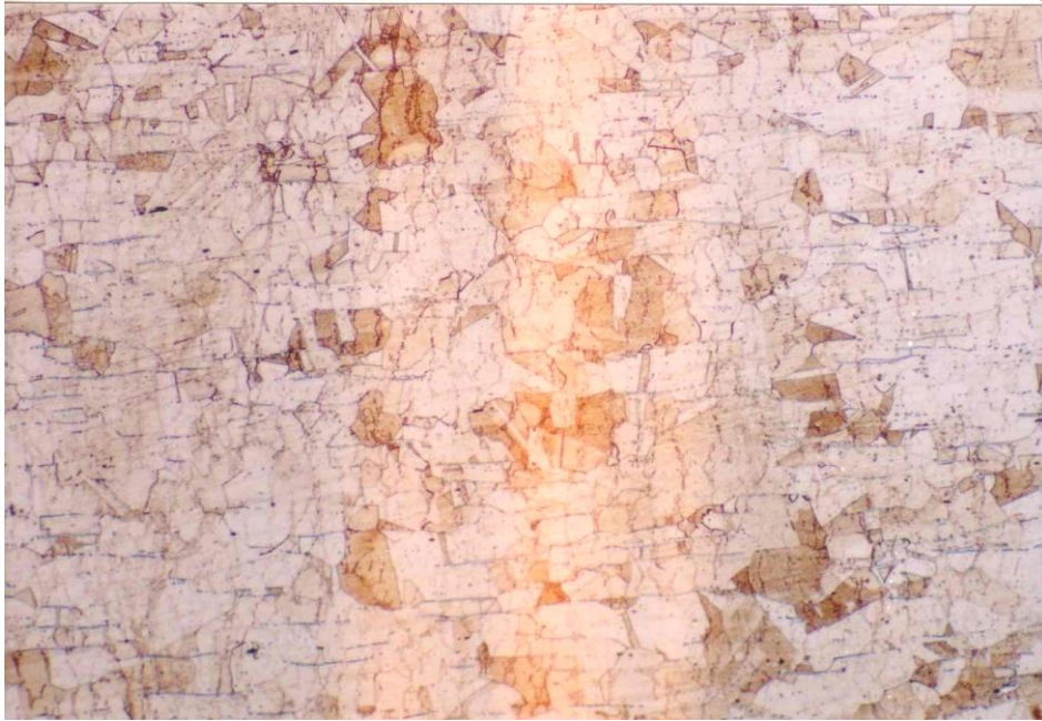
Figura 4.3 Microestructura del acero 316L. Se observan delineados los límites de grano. Aumento 100x.
