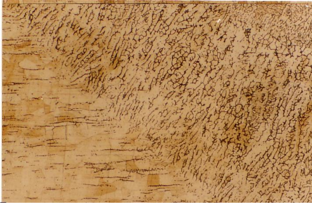
Figura 4.12 Se observa una morfología del tipo vermicular próxima la zona de fusión y ferrita acicular en la ZAT. Aumento 200x
