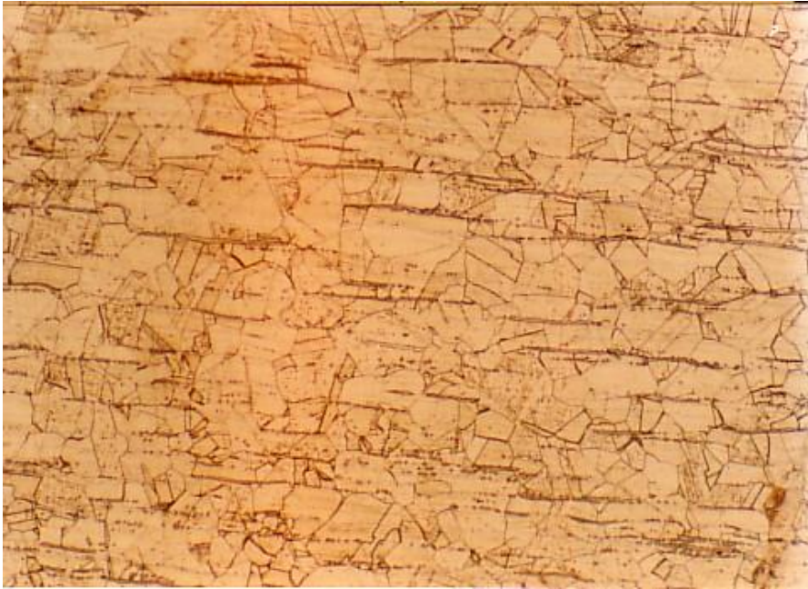
Figura 4.1 Microestructura del acero 304. Muestra inclusiones de sulfuro alineadas en dirección del laminado. Aumento 100x
