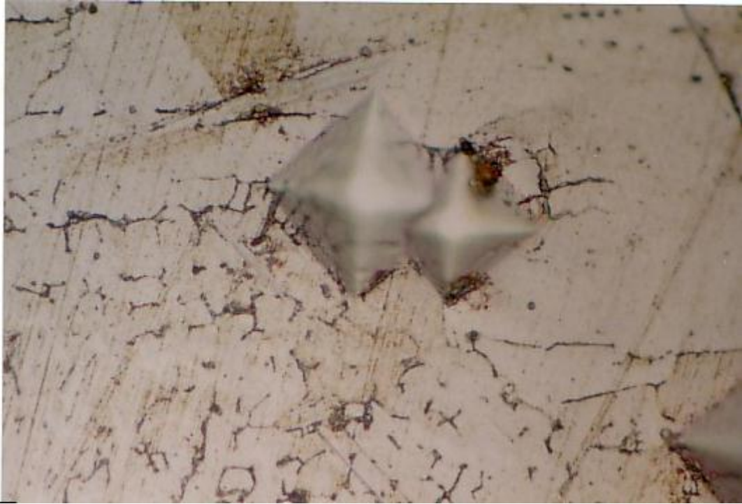
Figura 4.38 Medidas de microdureza en la ZAT en límite ferrita-austenita. Aumento 1000x.
