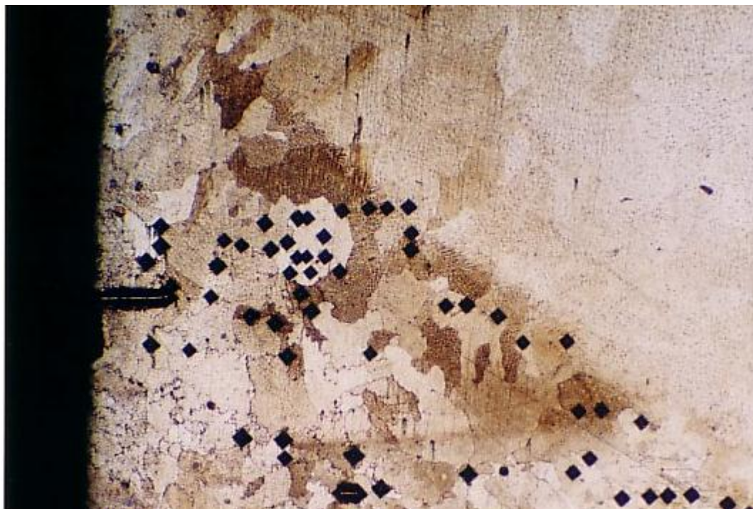
Figura 4.34 Muestra el barrido de la zona mediante medidas de microdureza. 50x.
