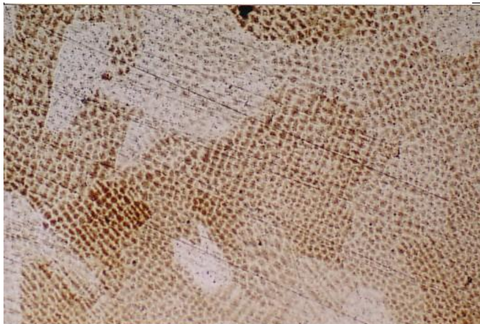
Figura 4.5 Se observa una estructura del tipo dendrítica en la zona de fusión. 1000X
