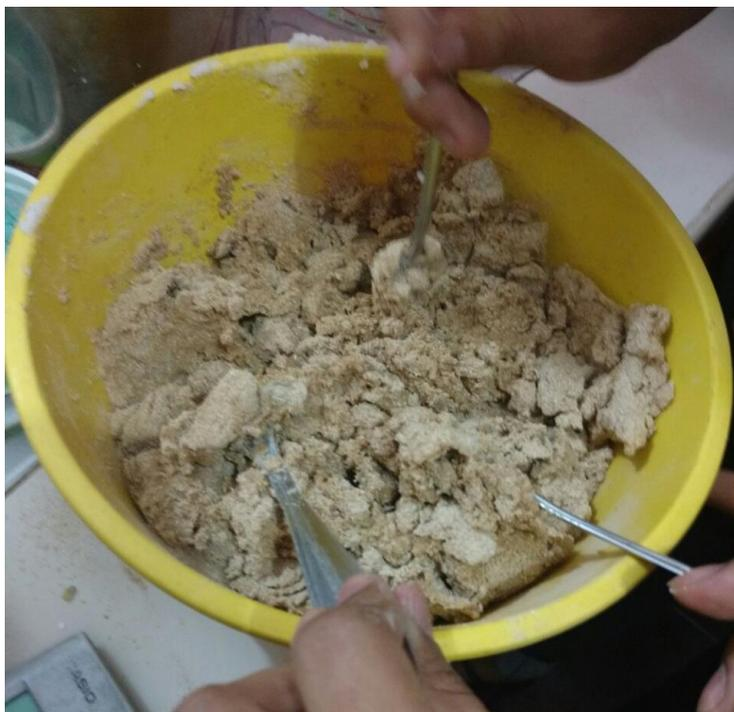
Figura 40. Mezclado de goma de almidón de arroz y cascarilla de arroz molida
