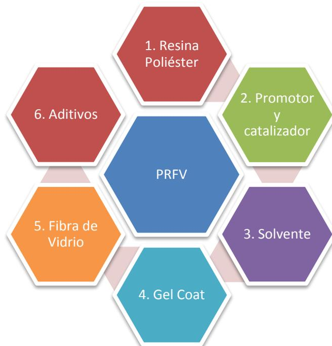
El Poliéster Reforzado con Fibra de Vidrio (PRFV) es el resultado de la mezcla de todos estos insumos:
