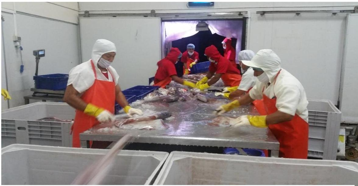
Figura 15. Recepción de la materia prima, proceso de vaciado, empujado y seccionado de la pota.
