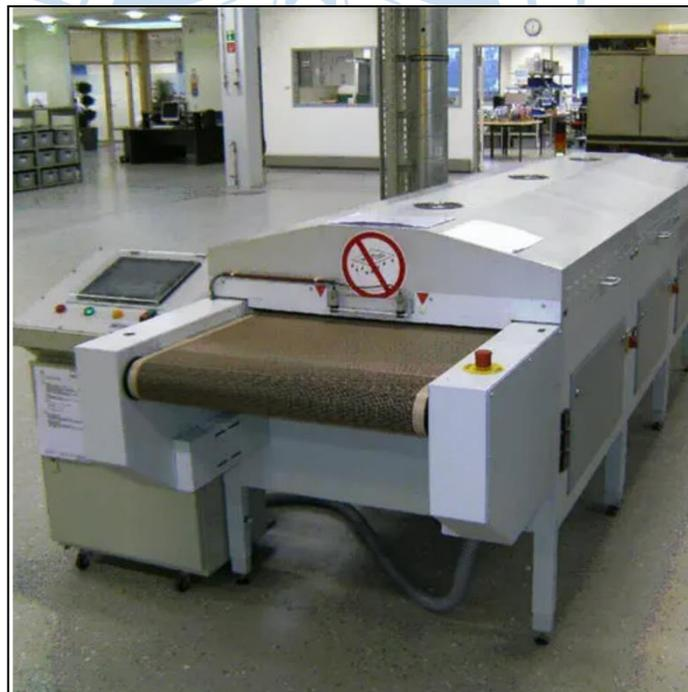
Figura 5: Deshidratador por convección Beltron GMBH
