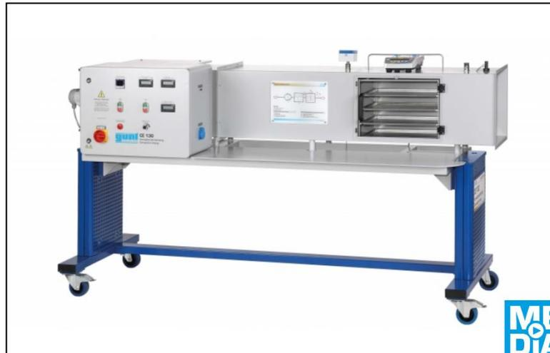
Figura 4: Deshidratador por convección industrial CE 130.
