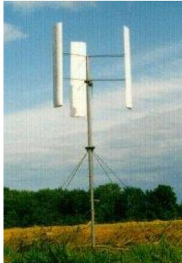
*Figura 4: Aerogenerador con rotor Giromill*
