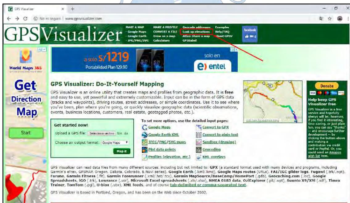
7. Ingresamos el archivo “NUBE DE PUNTOS”, y convertimos y adicionamos las respectivas elevaciones para cada punto mediante la opción Convert & add elevations.
