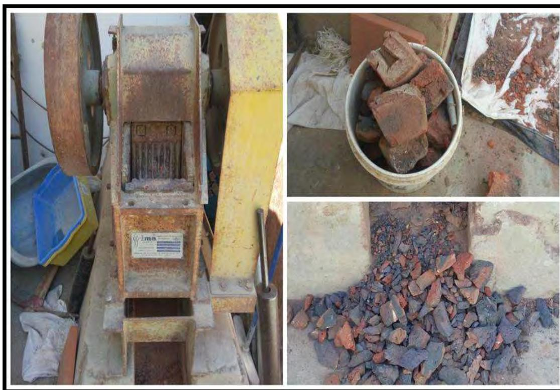
**Figura 15: Chancadora utilizada para elaboración de ladrillo triturado.**
