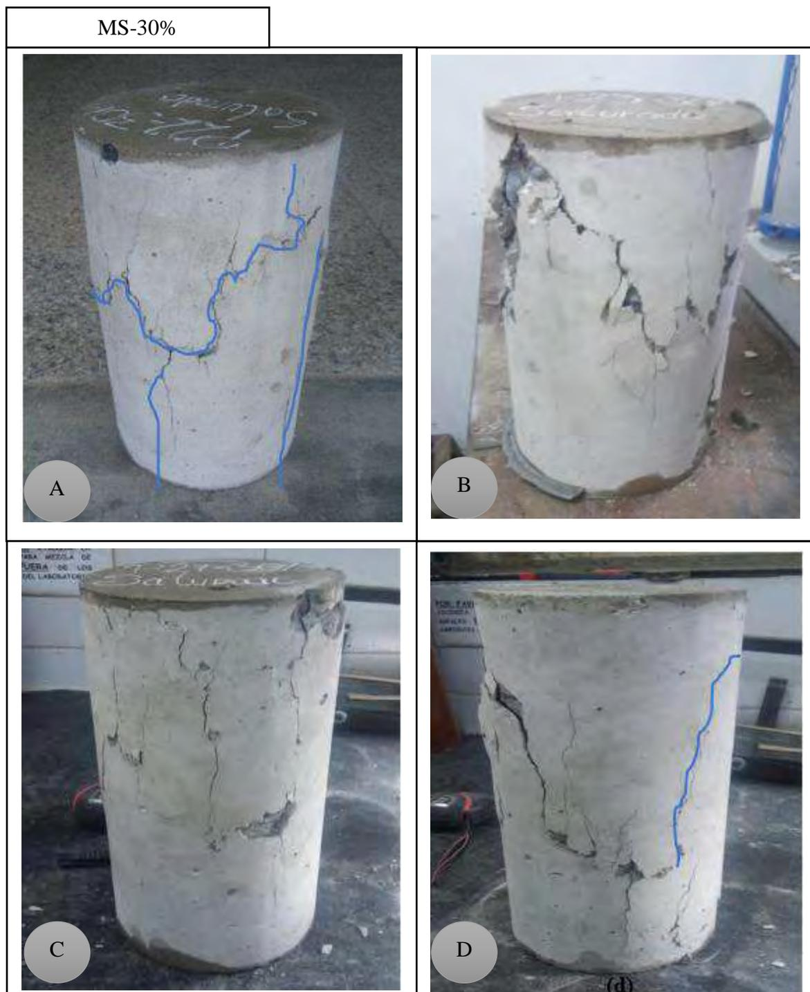
**Figura 34:** Figura resumen de los diferentes tipos de roturas de probetas en la muestra MS-30%.
