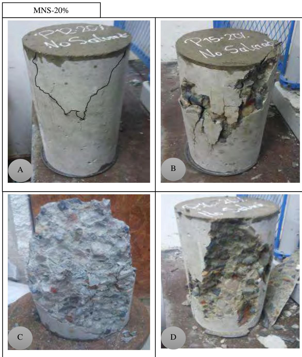
**Figura 37: Figura resumen de los diferentes tipos de roturas de probetas en la muestra MNS-20%.**
