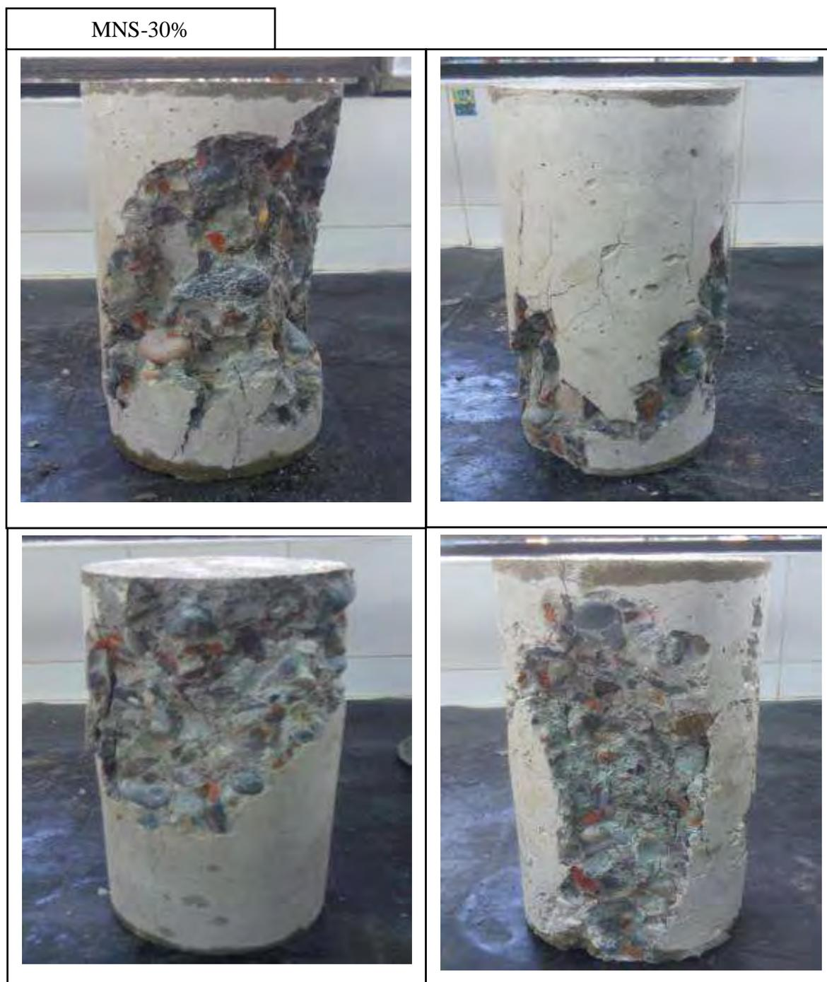
**Figura 38:** Figura resumen de los diferentes tipos de roturas de probetas en la muestra MNS-30%.
