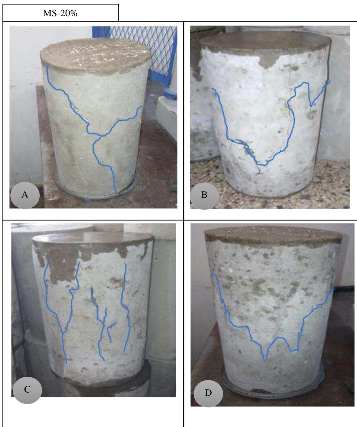
**Figura 33: Figura resumen de los diferentes tipos de roturas de probetas en la muestra MS-20%.**
