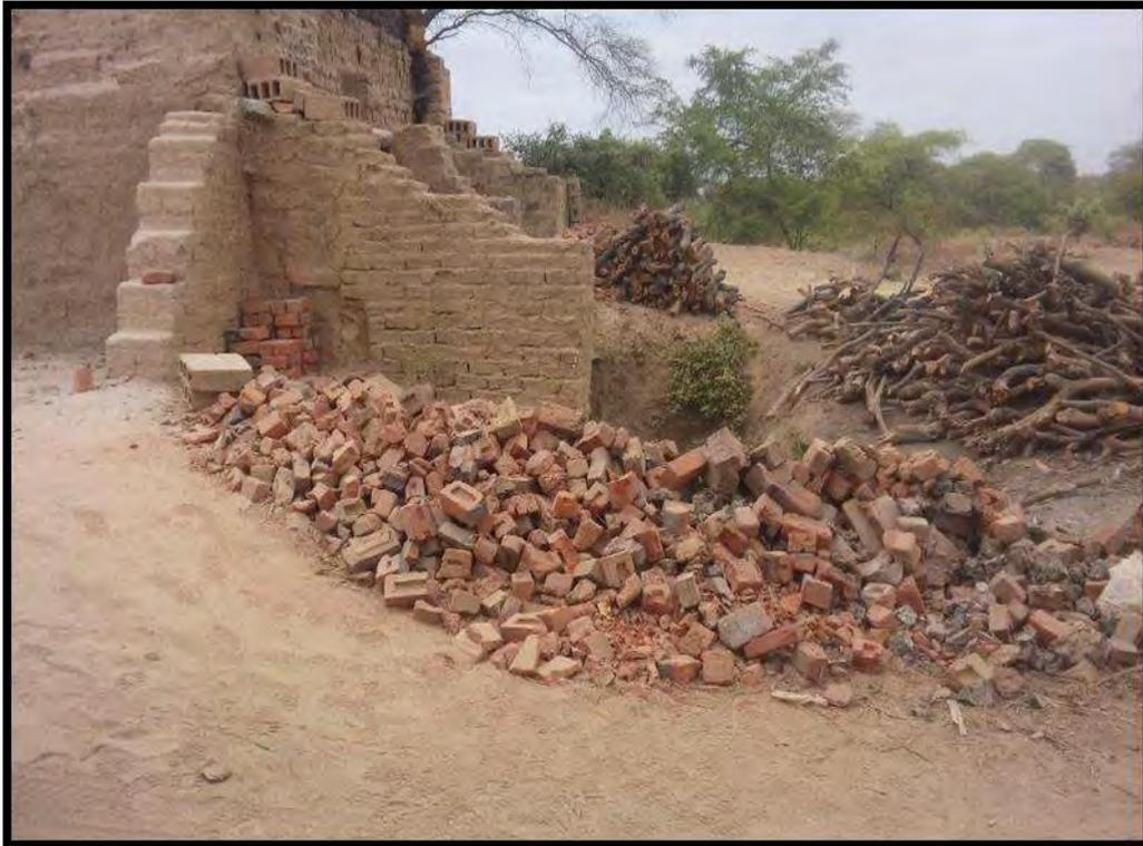
**Figura 12: Ladrillo desechado por exceso de cocción.**
