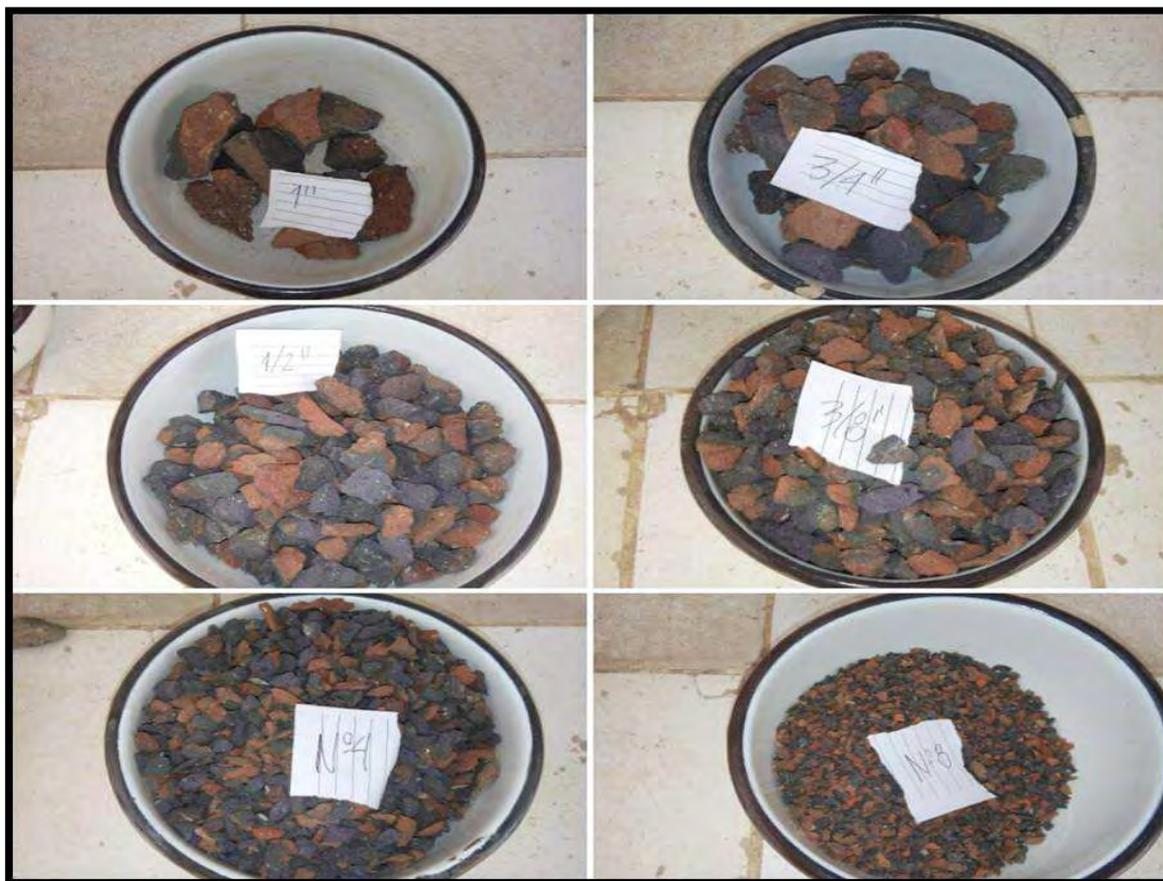
**Figura 16: Tamaños de agregado de ladrillo triturado obtenidos después del tamizado**
