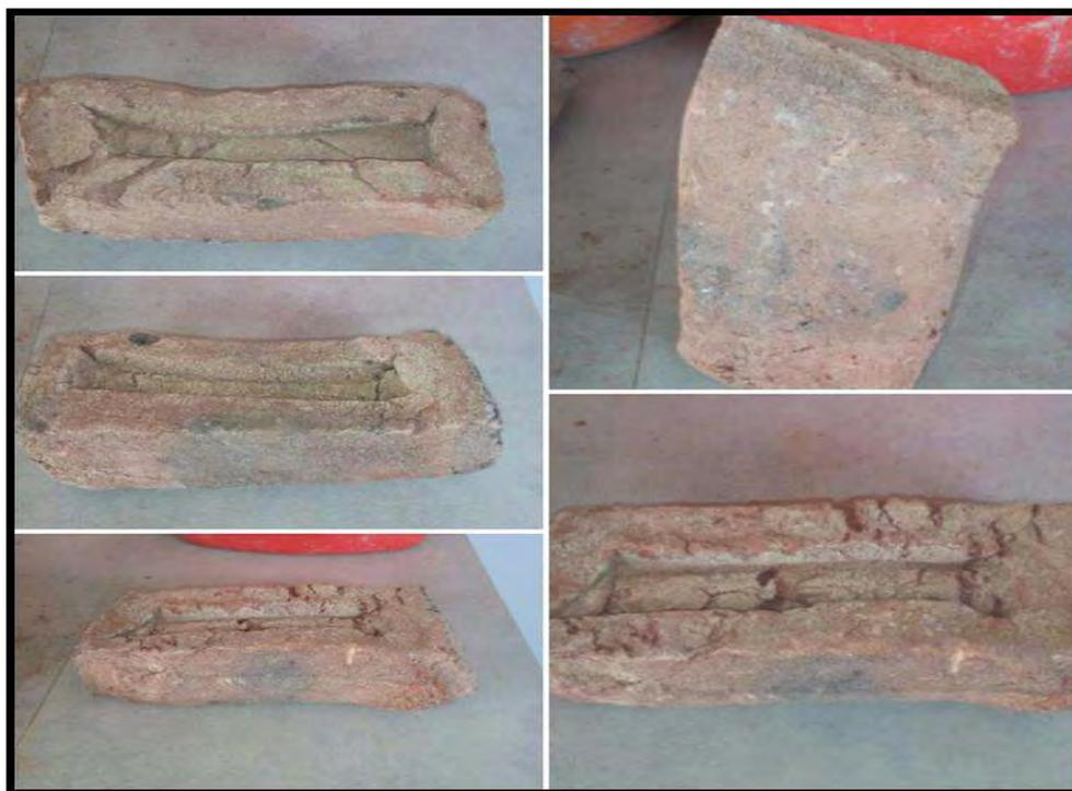
**Figura 14: Características físicas superficiales del ladrillo desechado, hinchamiento, coloración y deformación.**
