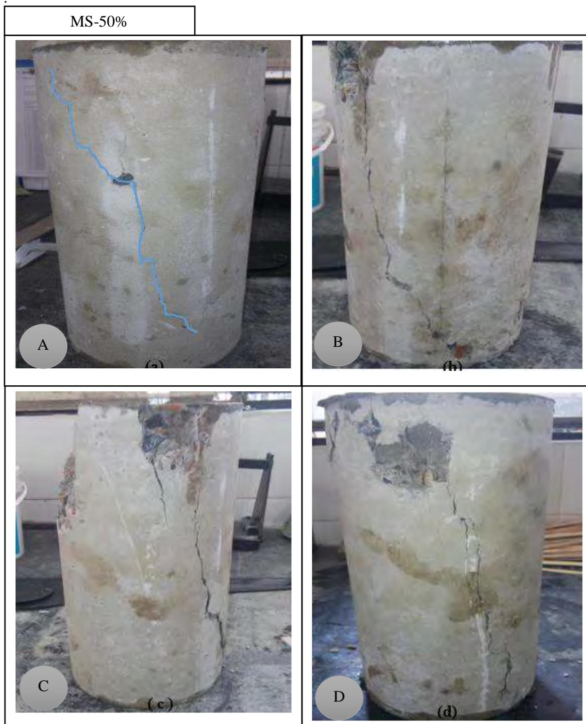
**Figura 36: Figura resumen de los diferentes tipos de roturas de probetas en la muestra MS-50%.**
