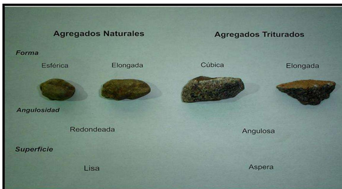
**Figura 2: Clasificación agregado grueso**
