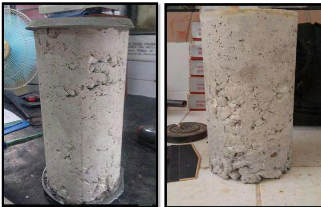
**Figura 31: Cangrejas en probetas.**
