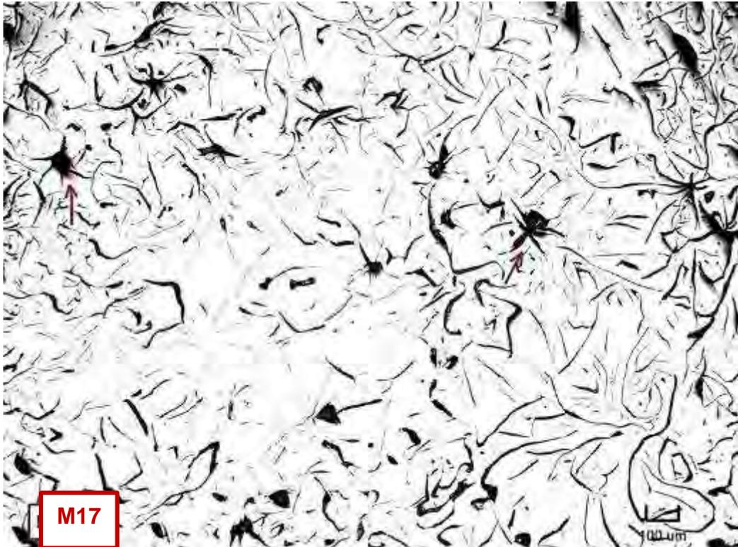
Micrografía C210. Microporos del tipo cavidades de contracción a lo largo de toda la zona transversal de la barra. Estado de pulido (no atacada). 137,08X
