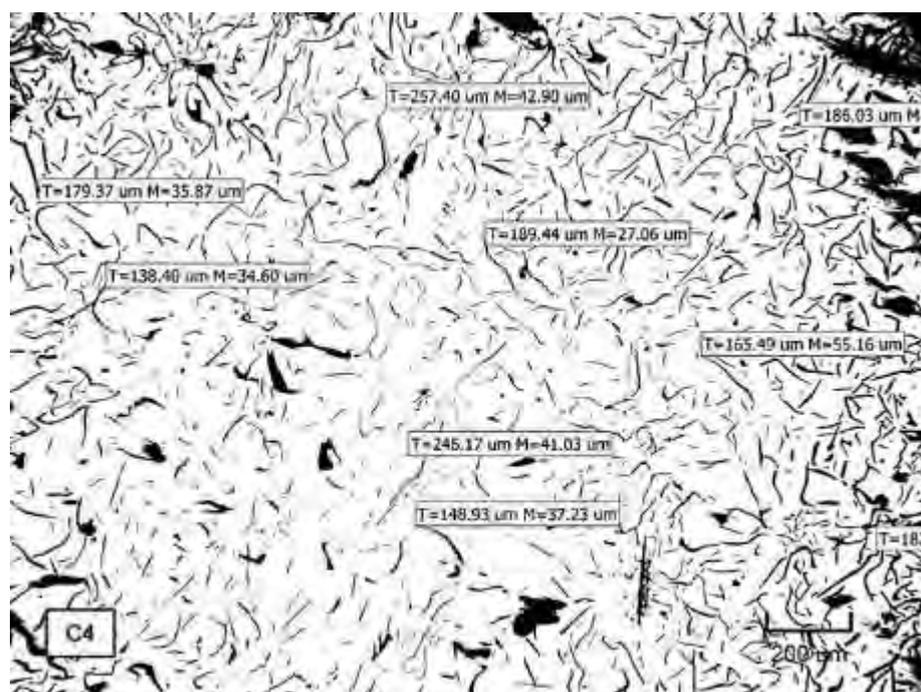
Micrografía D16. Medidas de las láminas de grafito que corresponden a tamaño N°4. Estado de pulido (no atacado). 137.08X
