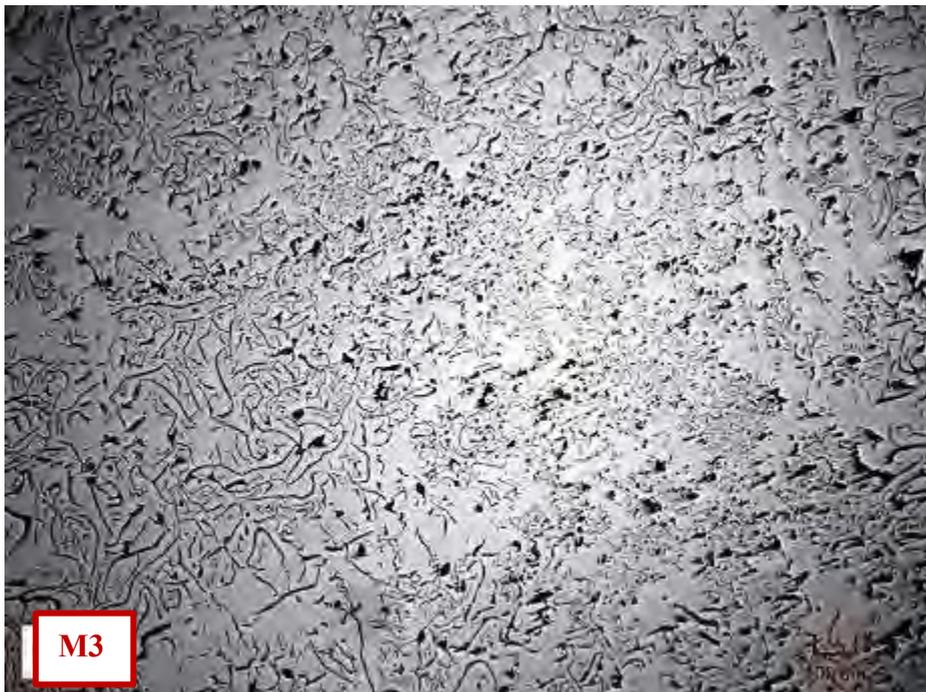
Micrografía C90. Láminas de grafito tipo D, forma I. Estado de pulido (no atacada).
