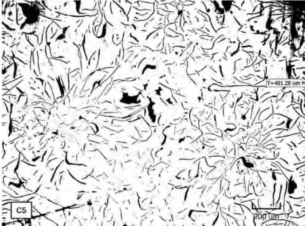
Micrografía D20. Tamaño de láminas de grafito N° 3 y N°4. Estado de pulido (no atacado). 137.08X
