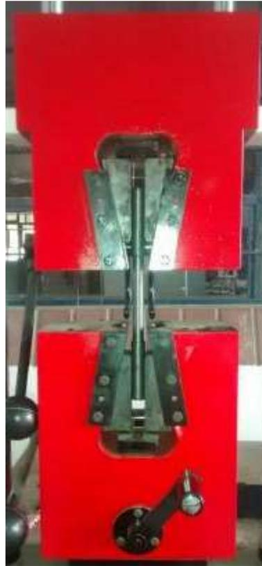
Figura 47. Probeta siendo traccionada
