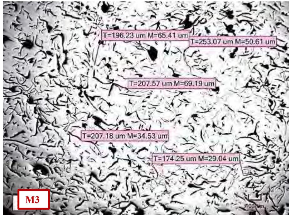
Micrografía C87. Medidas de láminas de grafito N°s 3 y 4. Estado de pulido (no atacado). 137.08X
