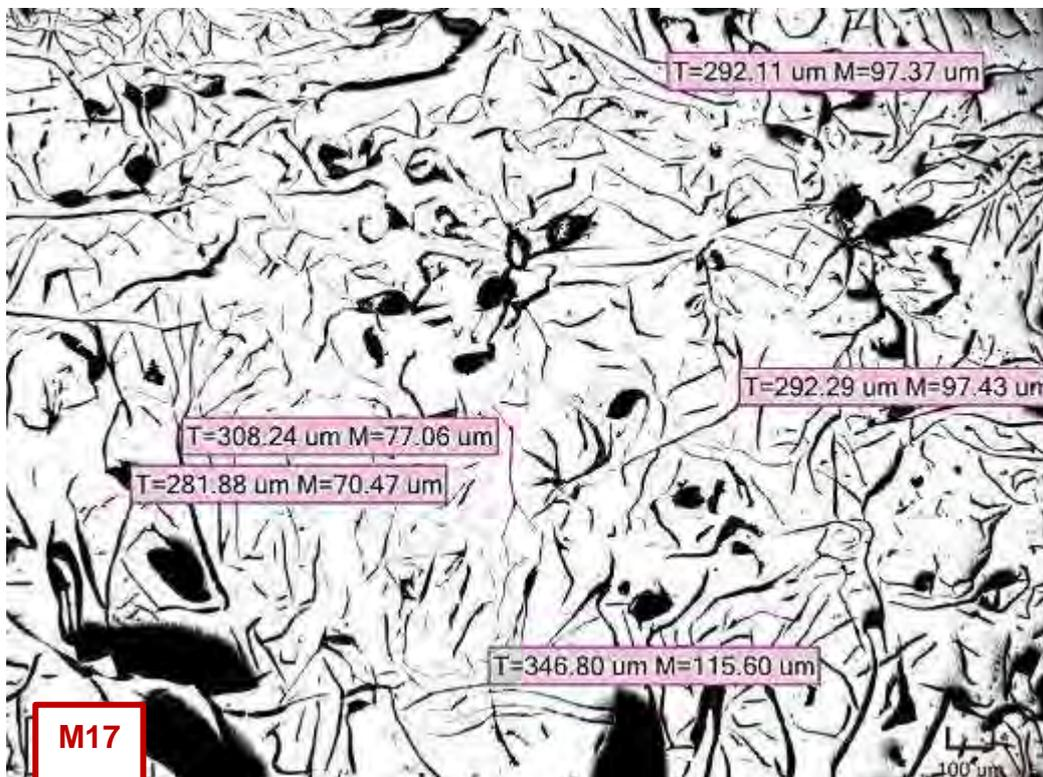
Micrografía C205. Medidas de las láminas de grafito que corresponde al tamaño N°3. Estado de pulido (no atacada). 137,08X
