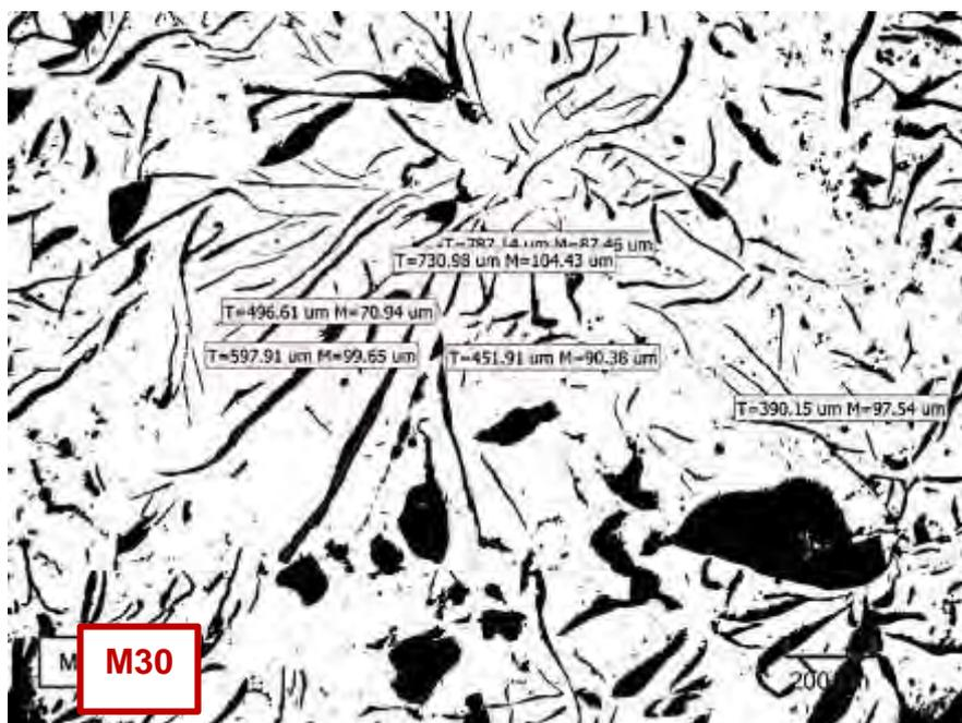
Micrografía C328. Tamaños de las láminas de grafito N°2 y N°3. Zona central. Estado de pulido (no atacado). 137.08X
