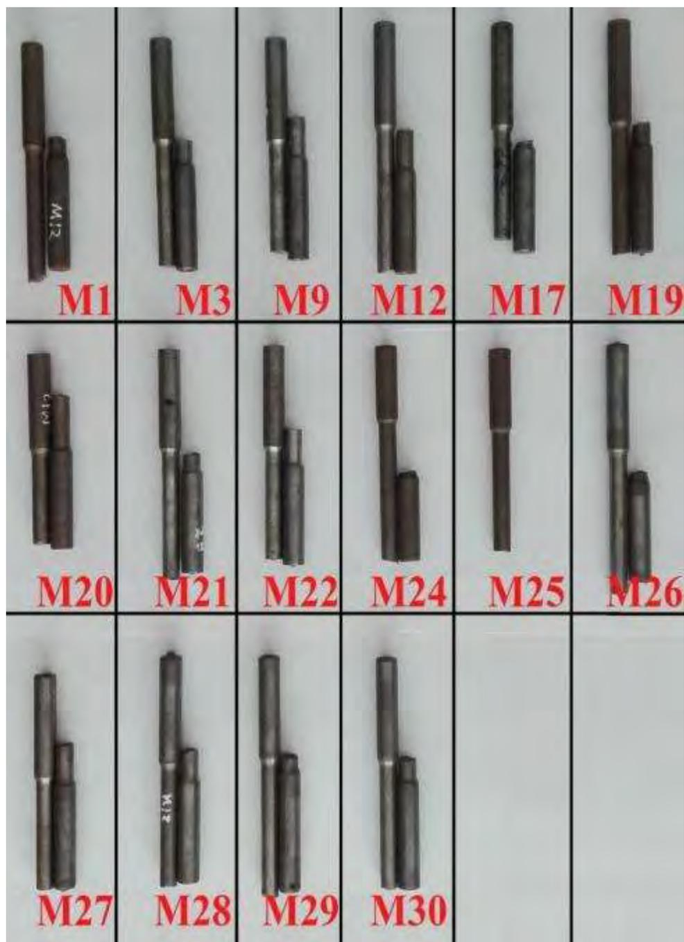
Figura 46. Probetas de tracción una vez ensayadas
