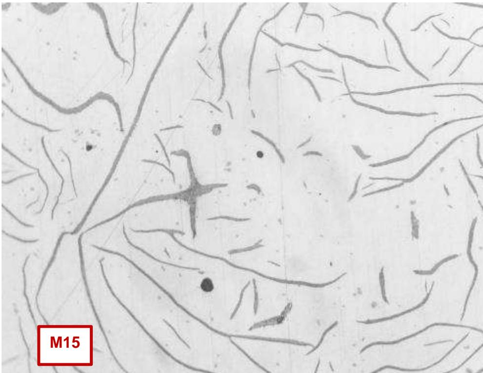
Micrografía C179. Láminas de grafito con distribución tipo A y B, forma I. Zona central. Estado de pulido (no atacado). 200X
