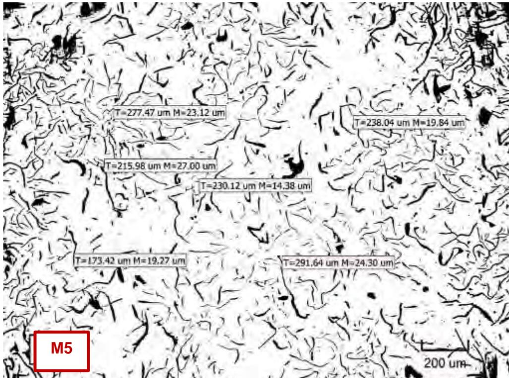
Micrografía C105. Medidas de las láminas de grafito que corresponden a tamaños N°2 y N°3. Estado de pulido (no atacado). 137.08X
