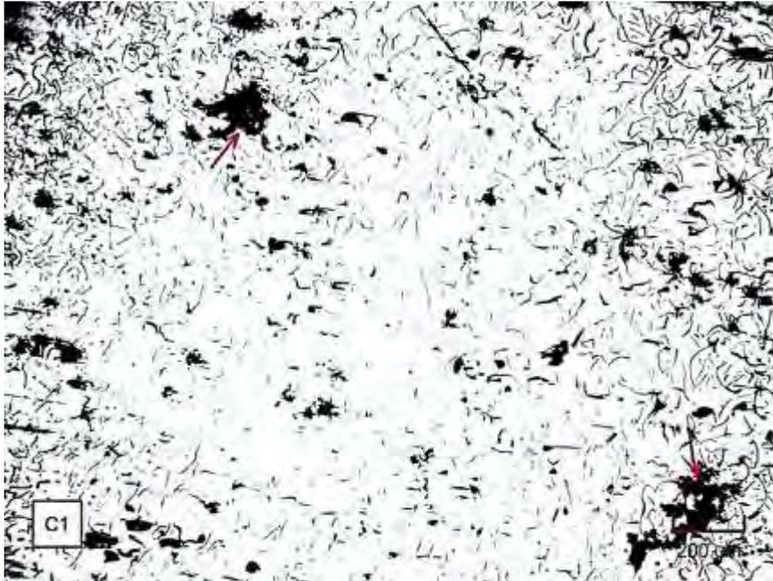
Micrografía D4. Se muestran microrechupes en el hierro fundido. Estado de pulido (no atacado). 137.08X
