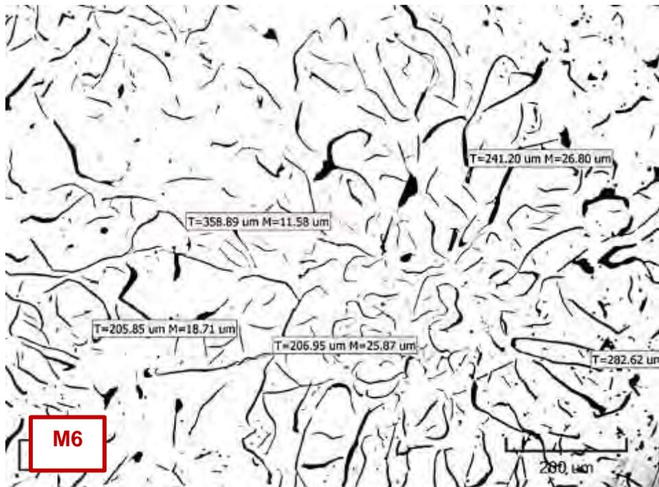
Micrografía C112. Tamaño de las láminas de grafito N° 3 y N° 4. Estado de pulido (no atacada). 137.08X
