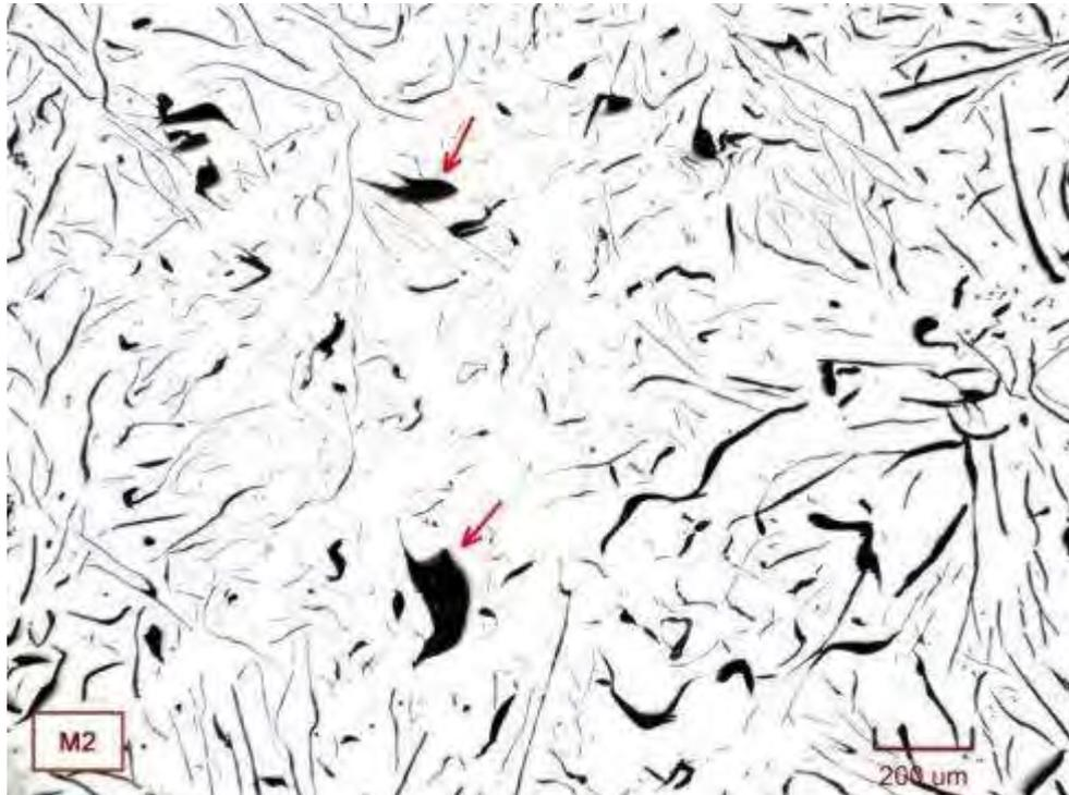
Micrografía C84.Microporos del tipo cavidades de contracción (áreas oscuras). Estado de pulido (no atacado). 137.08X
