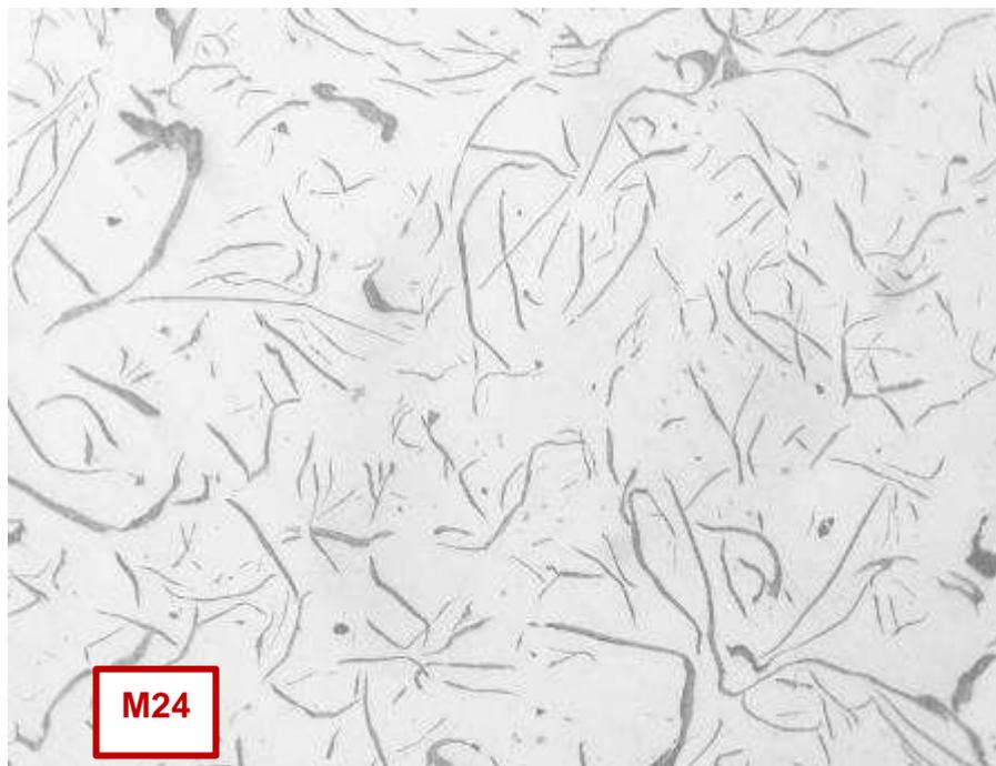
Micrografía C267. Forma I y distribución de las láminas de grafito tipo A y B. Zona central. Estado de pulido (no atacado). 200X
