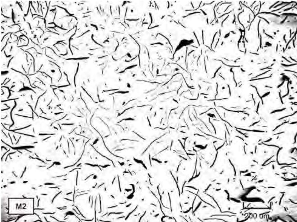
Micrografía C75. Grafito laminar tipo B, en la zona central. Estado de pulido (no atacado). 137.08X
