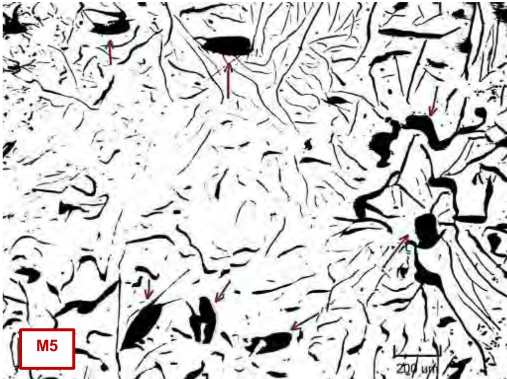
Micrografía C109. Microrrechupe en la zona intermedia de la pieza. Estado de pulido (no atacada). 137.08X.
