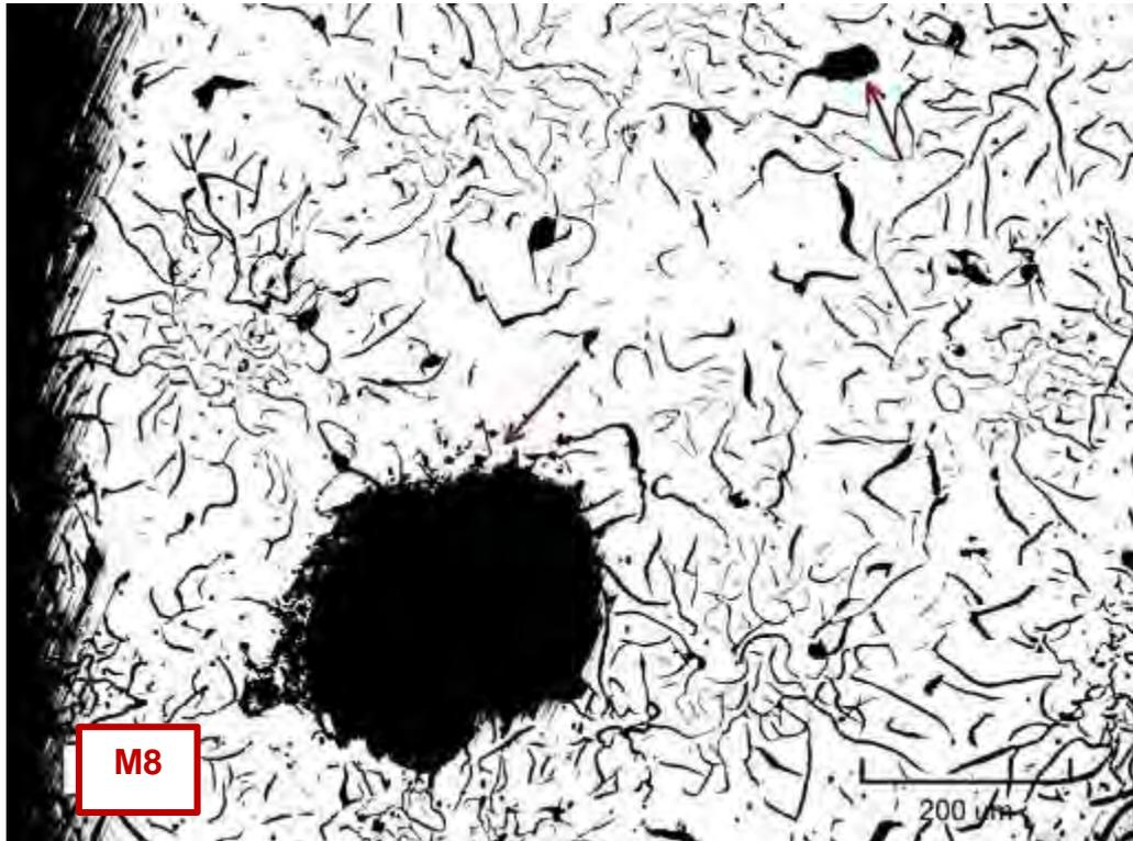
Micrografía C136. Poro producido por la reacción del carbono con el oxígeno, en la zona de la periferia de la pieza. Estado de pulido (no atacada). 137.08X
