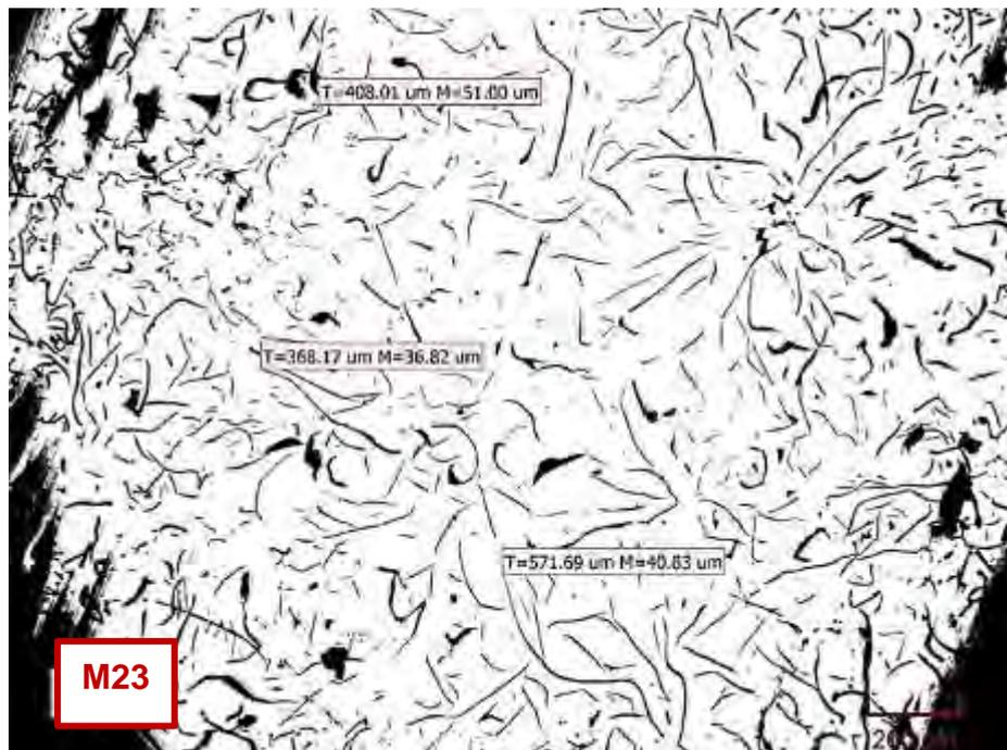
Micrografía C257. Tamaño de las láminas de grafito N°2 y N°3. Zona central. Estado de pulido (no atacado). 137.08X
