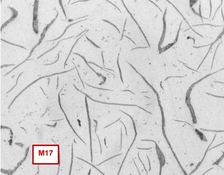
Micrografía C201. Láminas de grafito tipo A y B, forma I. Estado de pulido (no atacada). 200X
