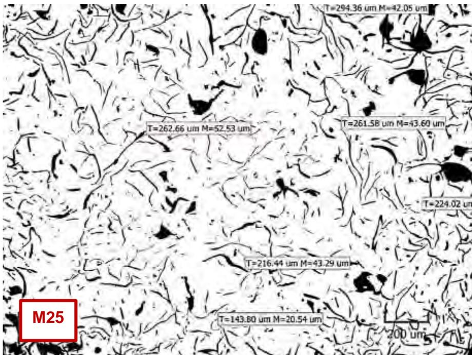
Micrografía C279. Láminas de grafito con tamaño N°3. Zona central. Estado de pulido (no atacado). 137.08X
