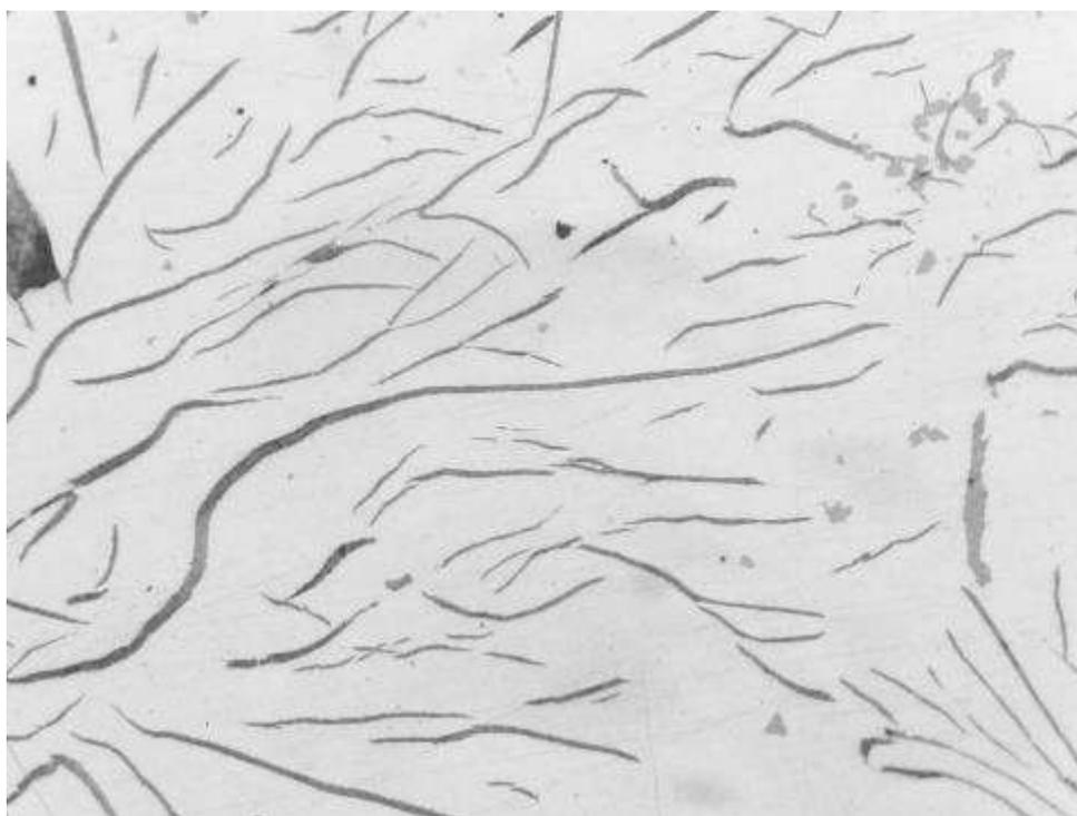
Micrografía C74. Grafito laminar tipo A, en la zona central. Estado de pulido (no atacado). 200X
