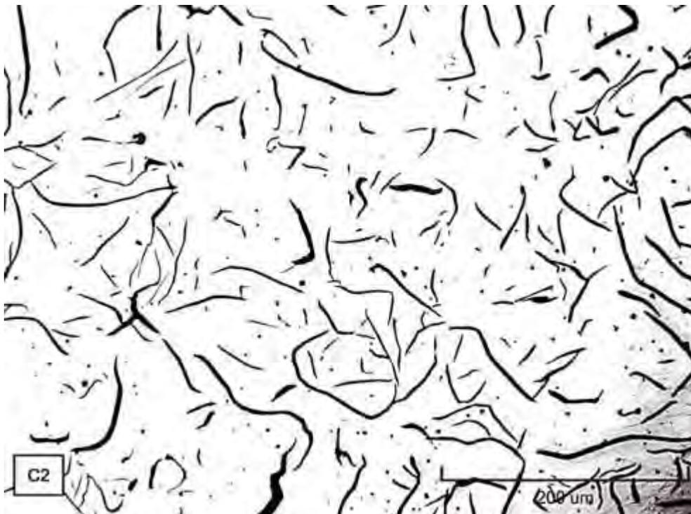
Micrografía D10. Sulfuros de manganeso en toda la pieza. Estado de pulido (no atacada). 548.33X
