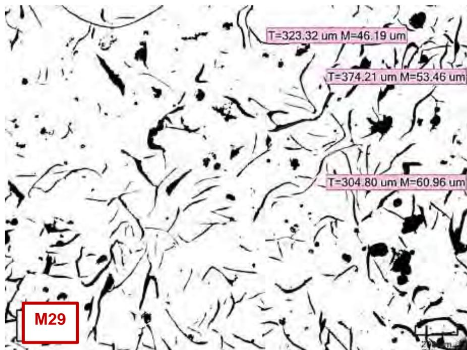
Micrografía C317. Láminas de grafito con tamaño N°3. Zona central. Estado de pulido (no atacado). 274.15X
