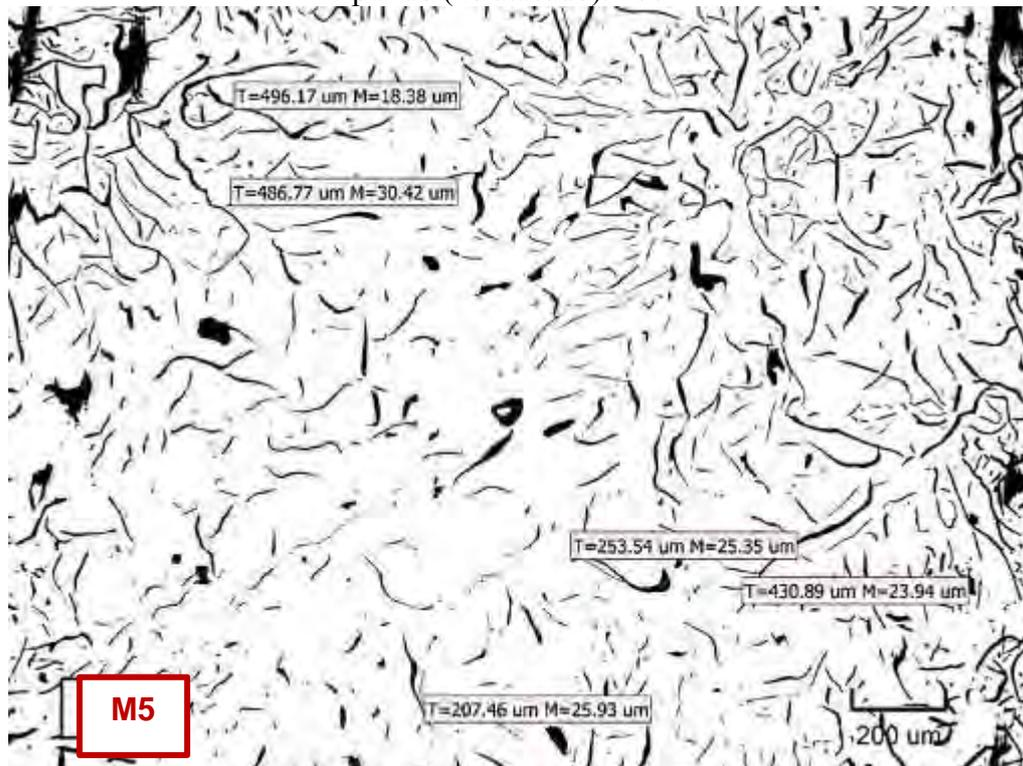
Micrografía C103. Medidas de las láminas de grafito que corresponden a tamaños N°2 y N°3. Estado de pulido (no atacado). 137.08X
