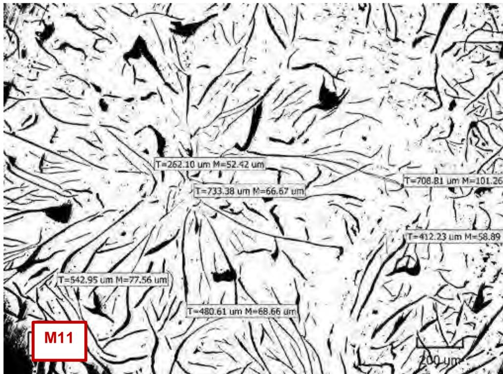
Micrografía C152. Medidas de las láminas de grafito que corresponde al tamaño N°2 y N°3. Estado de pulido (no atacada). 137,08X
