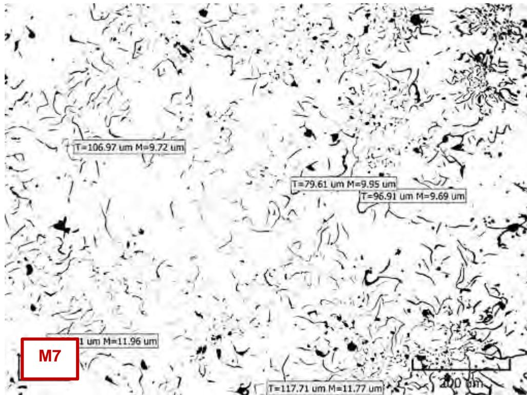
Micrografía C123. Tamaño de las láminas de grafito N°5. Estado de pulido (no atacada). 137.08X
