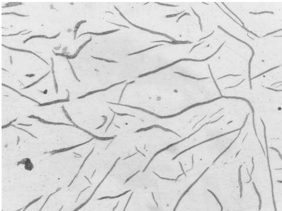
Figura 49. Micrografía 1 - Zona central de la muestra M2. Estado de pulido (no atacado). Presenta láminas de grafito tipo A, con tamaño N° 3. 200X.
