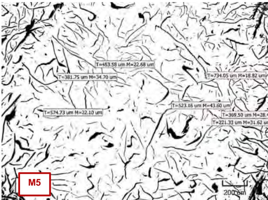
Micrografía C100. Tamaño de grafito N°2 y N°3, en la zona central de la pieza. Estado de pulido (no atacado). 137.08X
