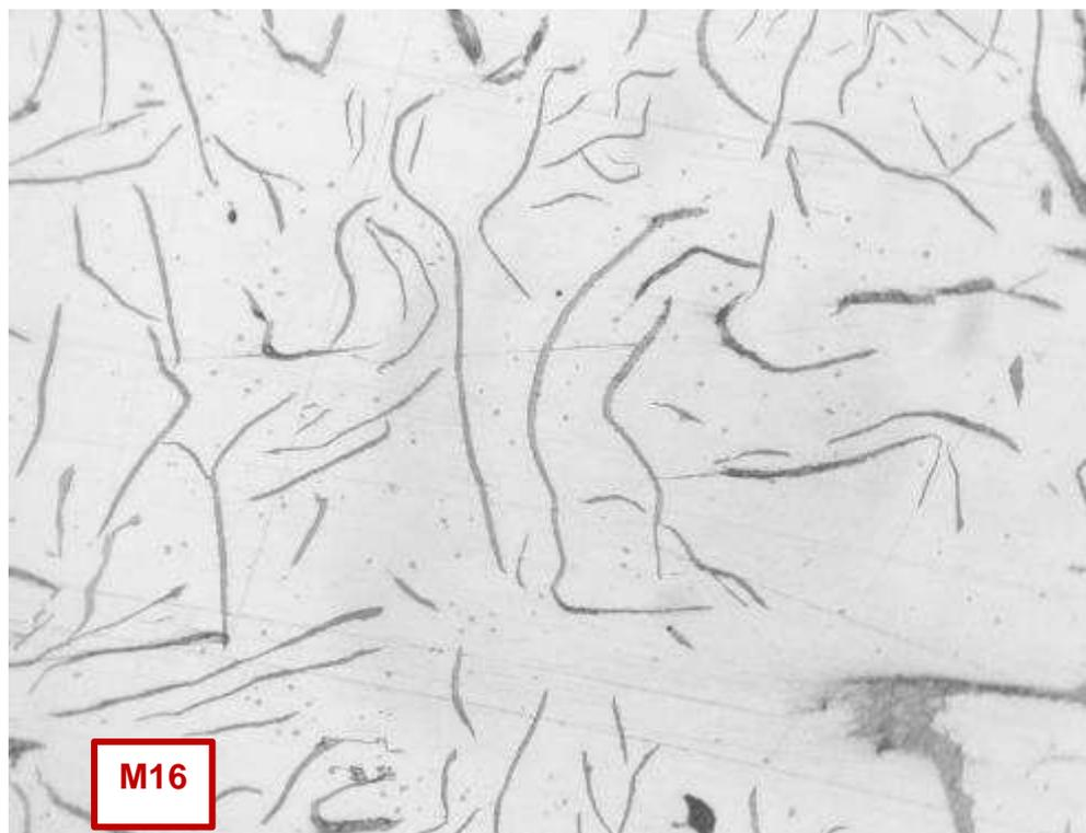
Micrografía C190. Láminas de grafito (forma I), con distribución tipo A y B. Zona central. Estado de pulido (no atacado). 200X
