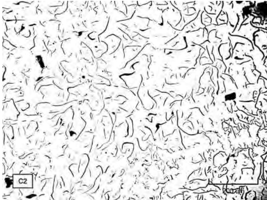
Micrografía D5. Hierro gris con una distribución tipo A y forma I, en la zona central de la pieza. Estado de pulido (no atacado). 137.08X
