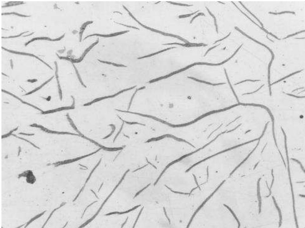
Micrografía C78.Láminas de grafito tipo A y forma I. Estado de pulido (no atacada). 200X
