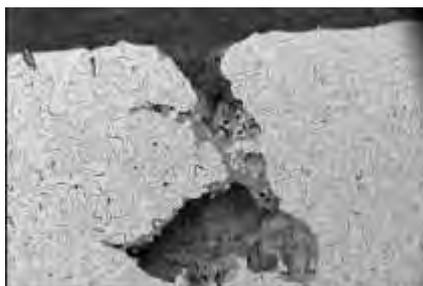
Figura 7. Defecto tipo sopladura
