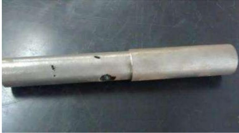
Figura 36. Probeta de tracción con defectos
