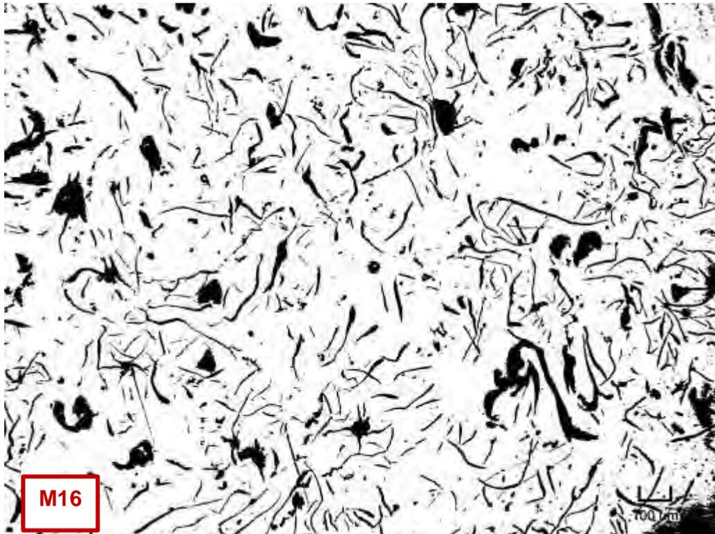
Micrografía C196. Láminas de grafito (forma I), con una distribución tipo A y B. Zona periferia. Estado de pulido (no atacado). 137.08X
