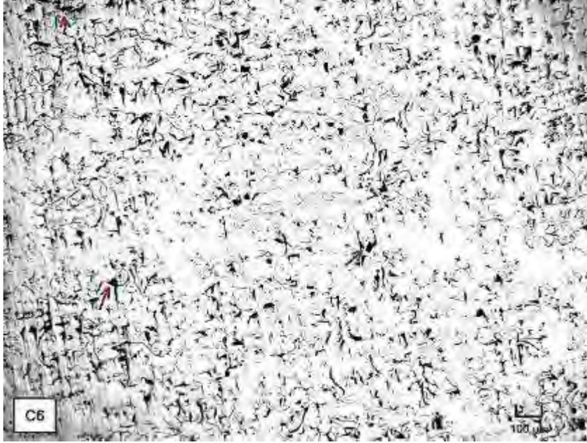
Micrografía D27. Microporos en la superficie del hierro fundido. Estado de pulido (no atacado). 137.08X
