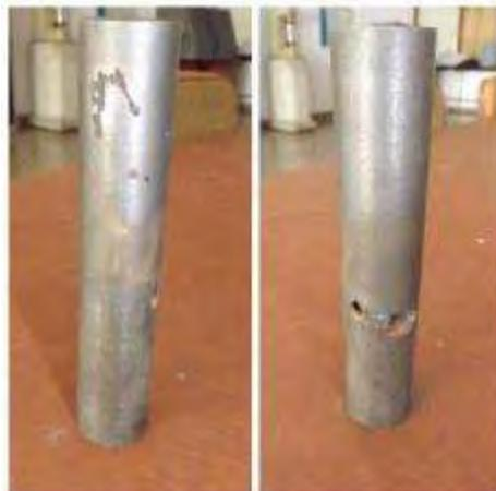
Figura 27. Probeta de tracción con defectos
