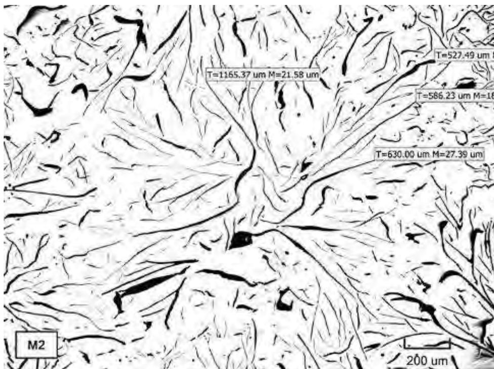
Micrografía C76. Medidas de láminas de grafito N°2 y N°3. Estado de pulido (no atacado). 137.08X
