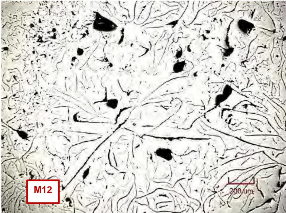
Micrografía C168. Microporos del tipo cavidades de contracción a lo largo de toda la zona transversal de la barra. Estado de pulido (no atacada). 137,08X
