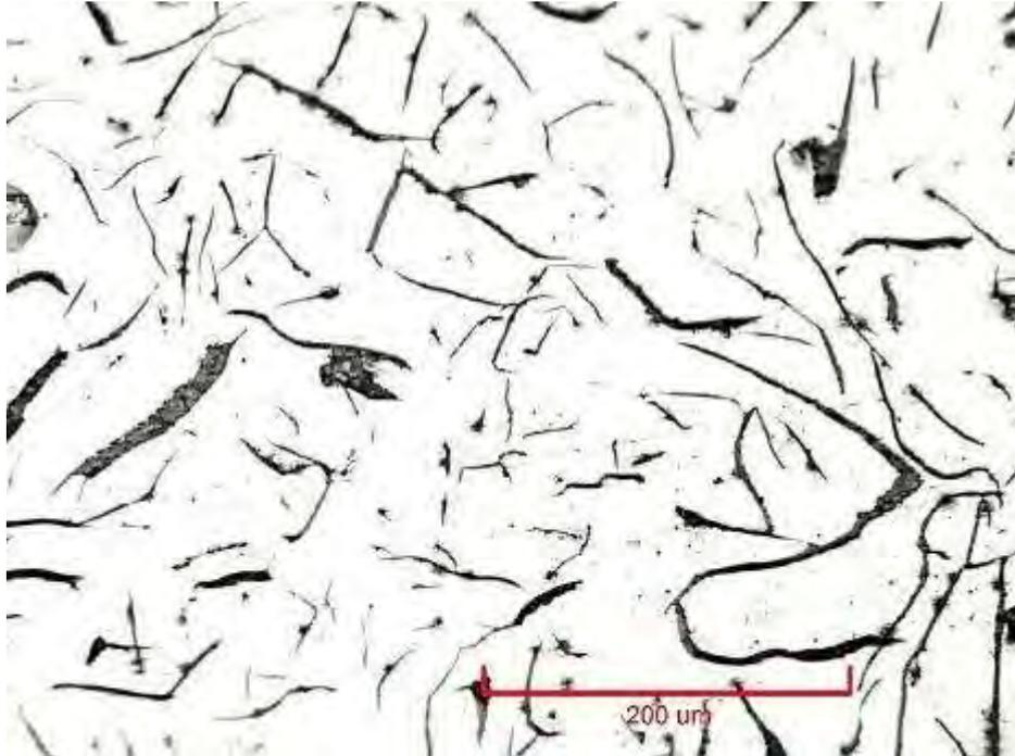
Micrografía D49. Partículas de Sulfuro de Manganeso. Estado de pulido (no atacado).
