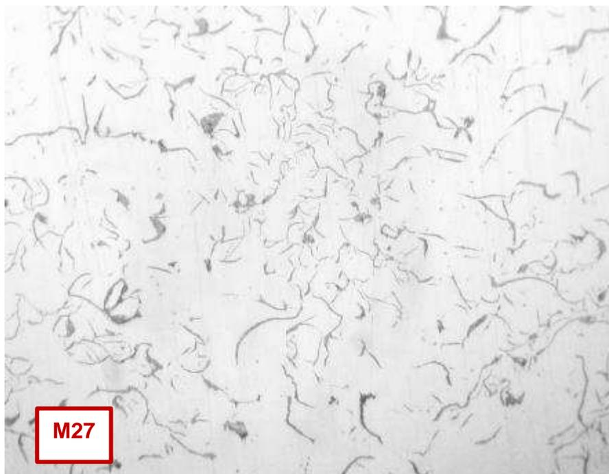
Micrografía C299. Láminas de grafito tipo B, forma I. Zona periferia. Estado de pulido (no atacado). 200X
