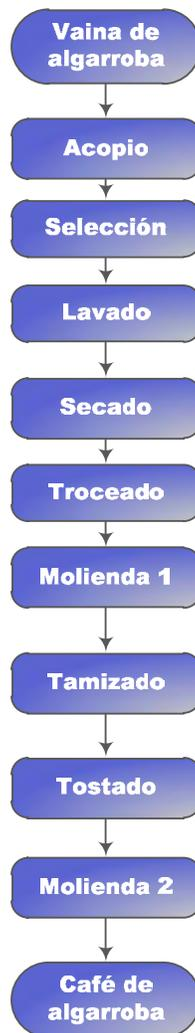
**Ilustración 4: Segundo método para la elaboración de café de algarroba**
