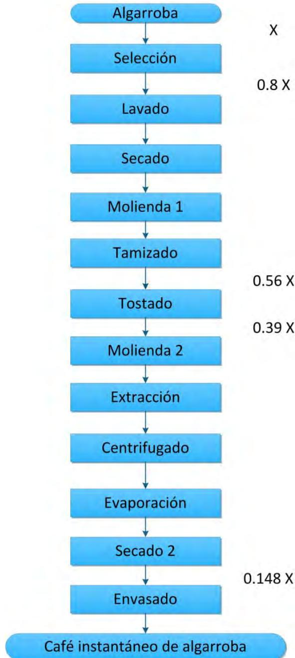
Ilustración 70: Diagrama de flujo con flujo de masa.
