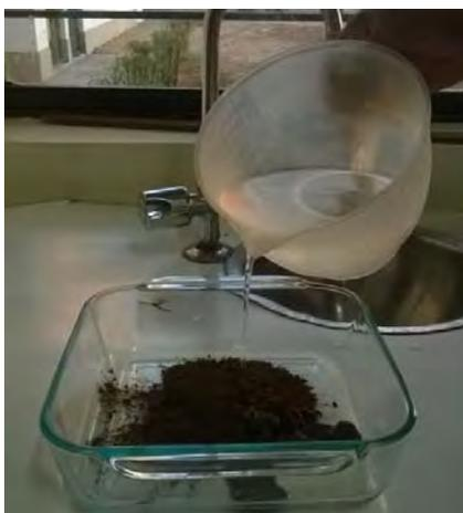
Figura: Proceso de Lixiviación
