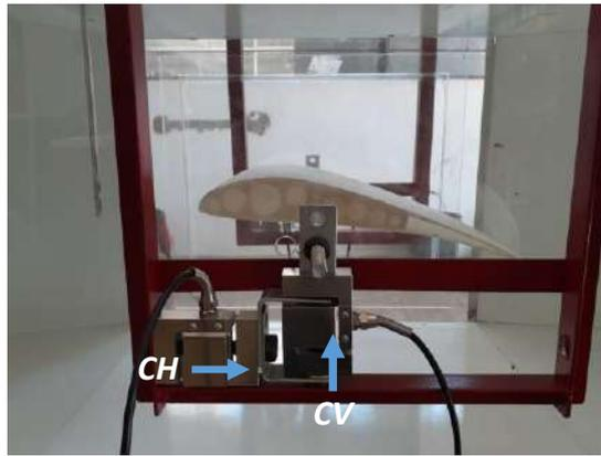
Figura 58. Disposición de celdas de carga y dispositivos auxiliares para control de fuerzas de sustentación y arrastre en sección de prueba de túnel.
