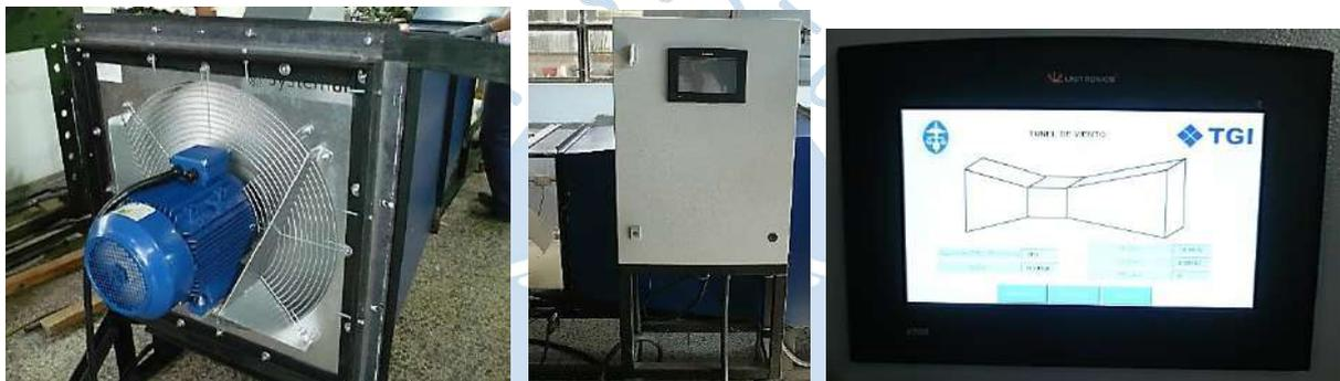
Figura 56. Extractor y tablero de comando con display.
