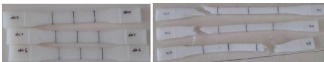
Figura 24. Tres de las probetas de nylon ensayadas.
