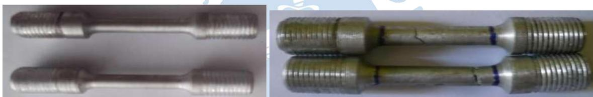
Figura 22. Probetas de fundición de aluminio local 50 % - 50 %.
