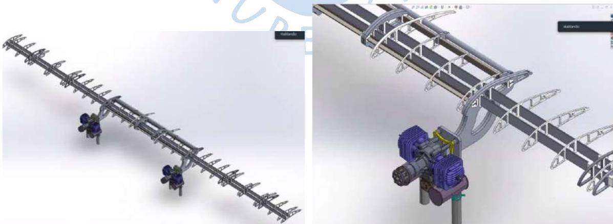
Figura 36. Estructura alar de tercer prototipo VANT.
