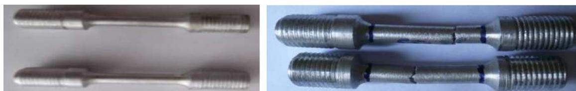
Figura 23. Probetas de fundición de aluminio local 65 % - 35 %.
