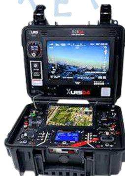
Figura 75. Estación de control tierra aire propuesto.
