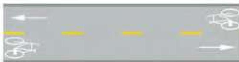
Figura 35. Línea discontinua de eje central para carril bidireccional.
