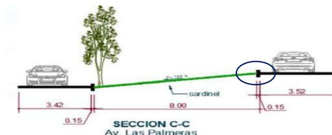
Figura 21. Detalle del separador central.
