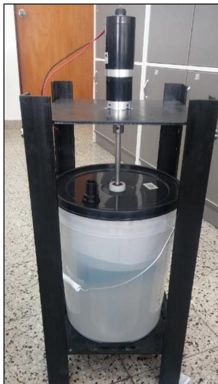
Figura 39. Presentación de motor, eje agitador y reactor
