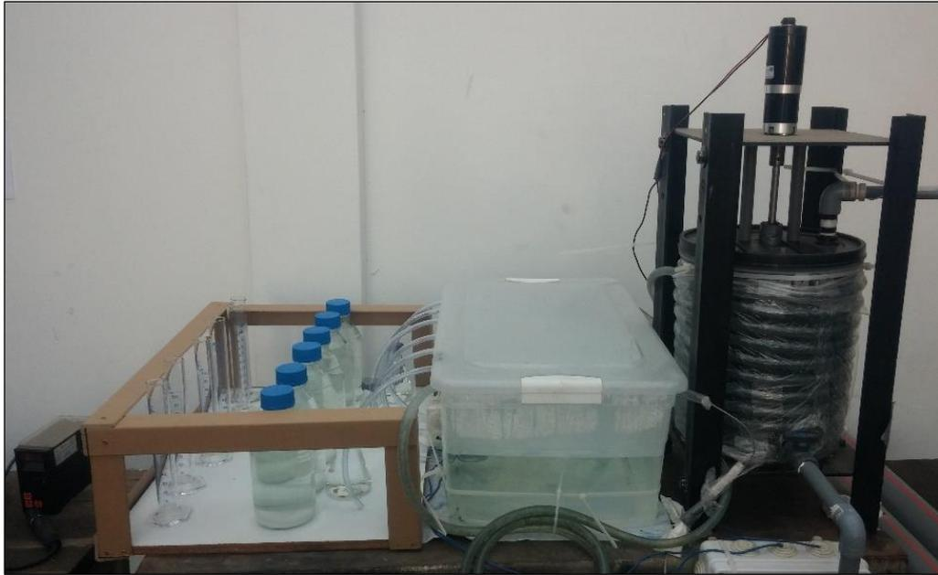
Figura 44: Reactor continuo antes de la puesta en marcha y antes de instalación de sistema de salida/acumulación de biogás.
