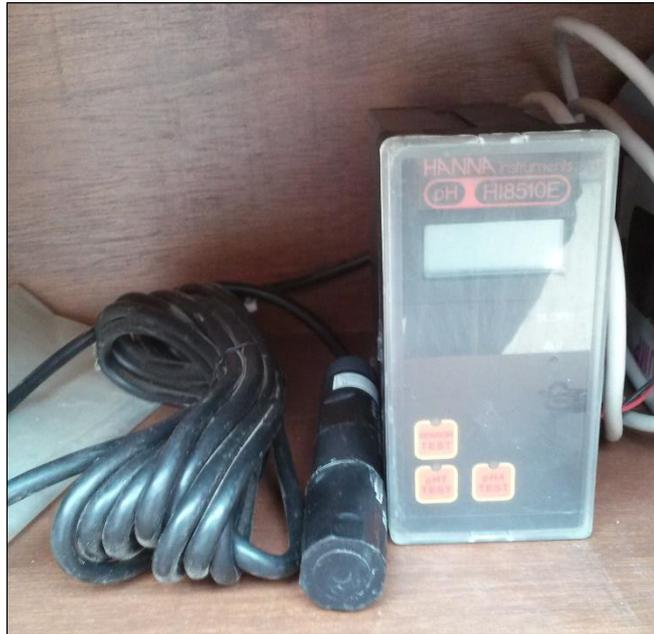
Figura 51. Instrumentos usados para la medición de pH del digestato. Electrodo modelo HI-1006-3205 y trasmisor HI-8510E de la marca Hanna Instruments.
