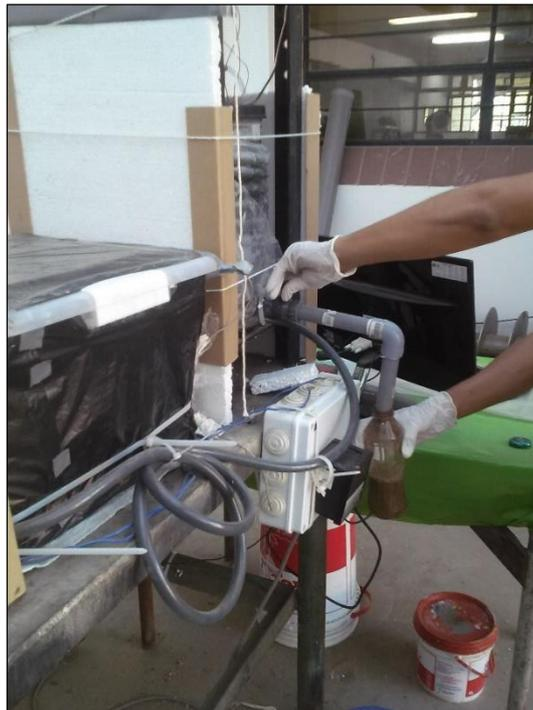
Figura 50. Extracción de muestra de digestato para medición de pH
