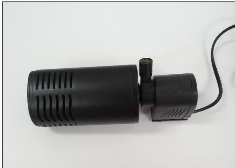
Figura 33. Bomba para circulación de agua en chaqueta de reactor.
