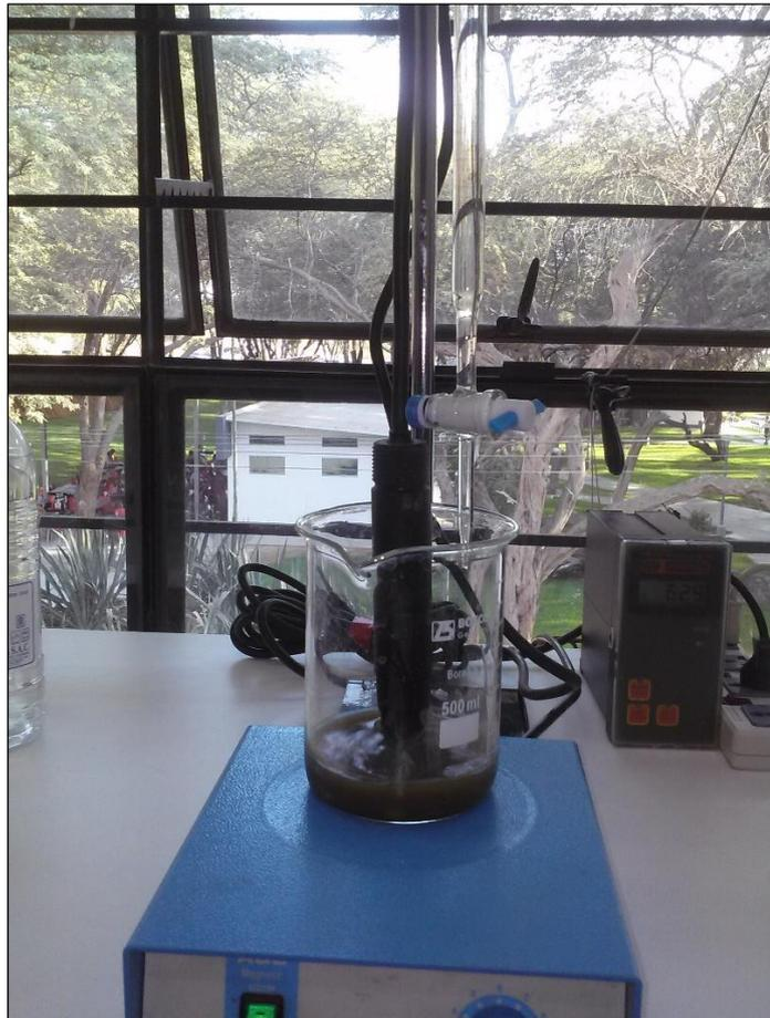
Figura 56. Titulación manual para determinación de ratio de alcalinidad
