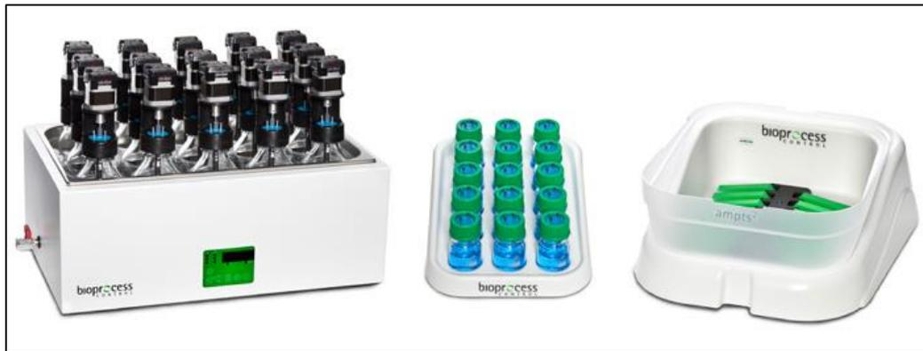
Figura 13. Equipo AMPTS II para ensayo BMP de la firma Bioprocess Control
