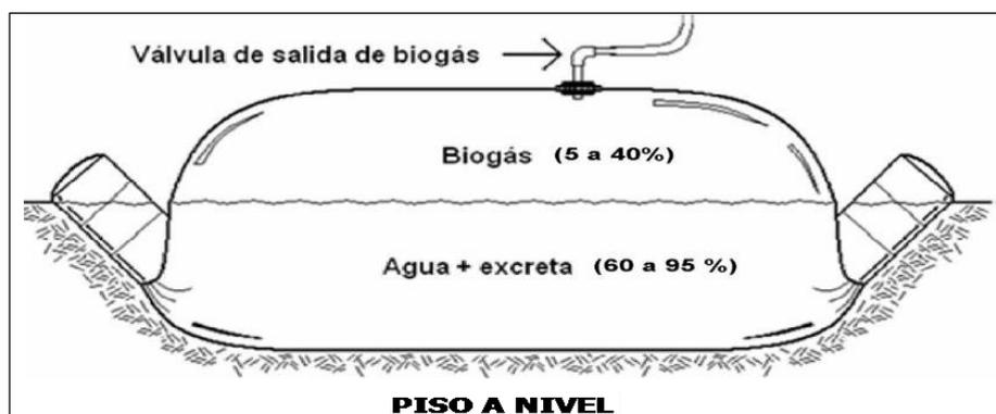
Figura 9. Biodigestor tubular
