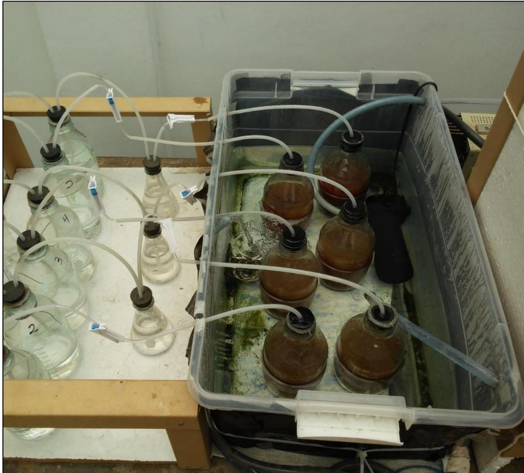
Figura 46. Ensayo BMP en funcionamiento
