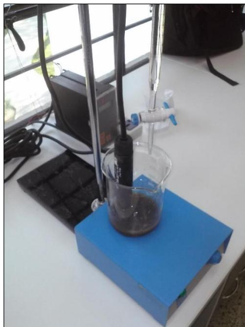
Figura 55. Monitoreo de descenso del nivel de pH en titulación manual
