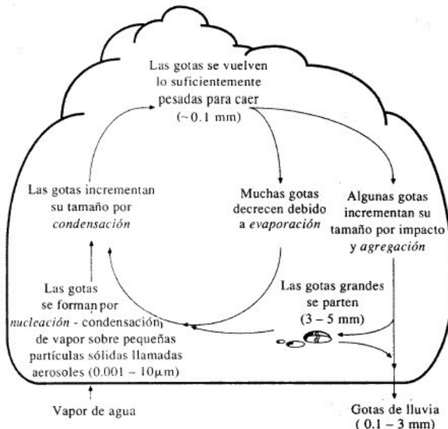
**Figura 2.1** Esquema representativo del mecanismo de formación de precipitación
