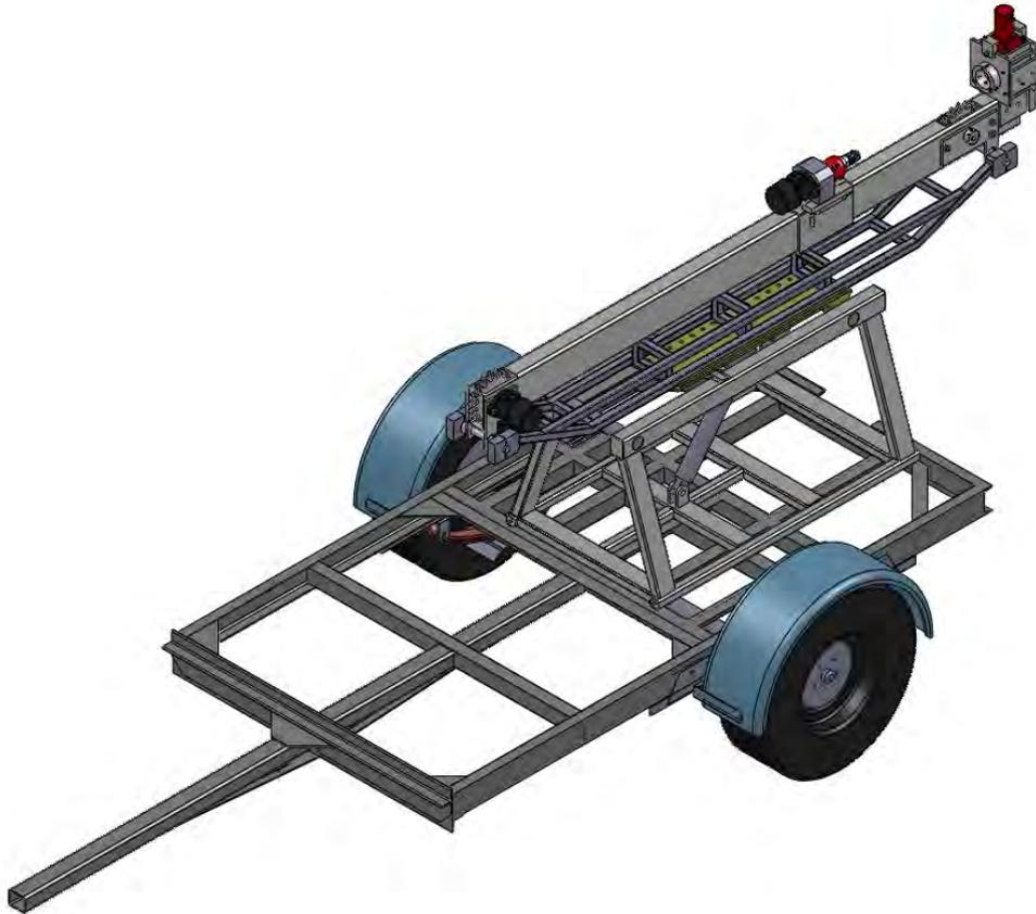
**Fig. 4.2. Vista lateral de la perforadora hidráulica.**
