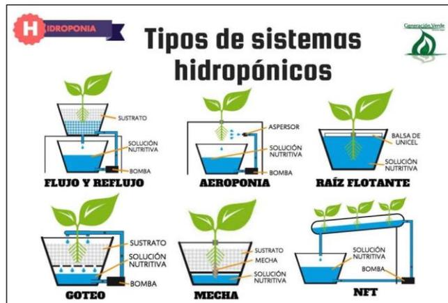
**Figura 9. Tipos de sistemas hidropónicos.**
