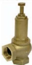
Cuerpo: **Latón** - Campana: **Latón** - Junta cierre: **Teflón (PTFE)** - Campo regulación: **2 a 8 bar** - Temp. máx: **130°C**
