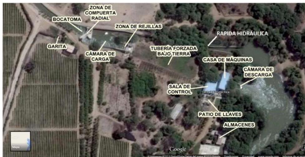
**Figura 39.** Elementos que conformar la central hidroeléctrica.
