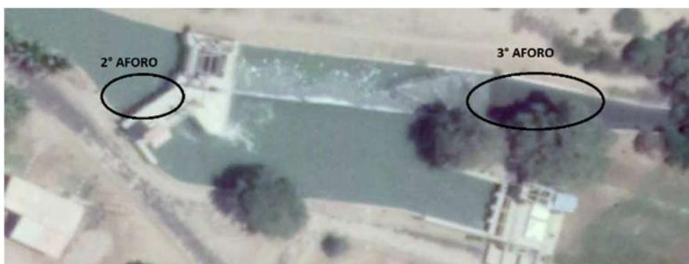
Figura 67. Aforos dentro de la central de Curumuy.
