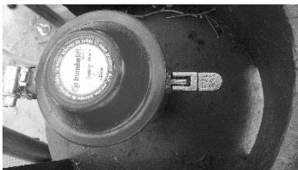
**Figura 40:** Encendido de la válvula de tanque de GLP
