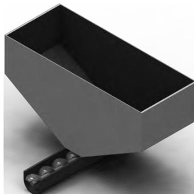
**Figura 25:** tolva diseñada en Solidworks
