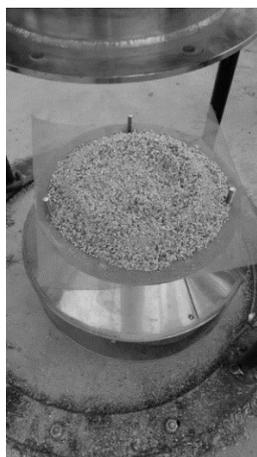
**Figura 22:** Placa distribuidora utilizada en el proyecto
