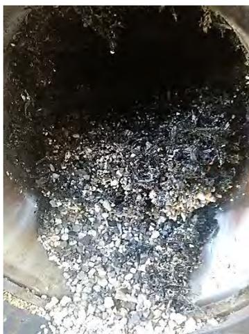
**Figura 37:** Aglomeración formada por la ceniza fundida de bauxita en el lecho
