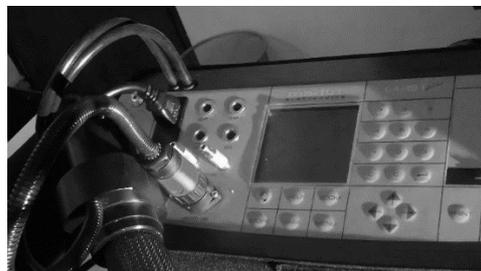
**Figura 19:** Analizador de gases propio del proyecto
