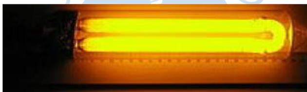
Figura 25. Lámpara de sodio de baja presión en funcionamiento.
