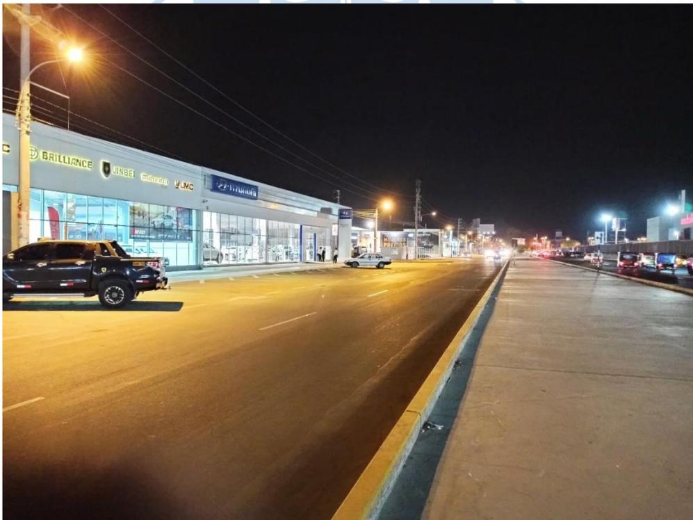
Figura 39. Lado izquierdo de la vía, notoriamente más iluminado que el derecho. Sin embargo, se verificó que la iluminancia sobre la vía es insuficiente según la norma peruana. Fuente: Elaboración propia.
