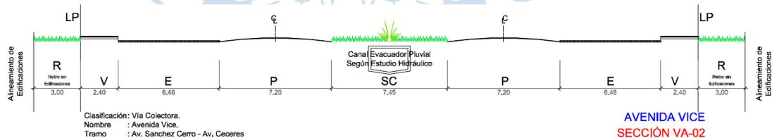
Figura 34. Sección transversal del tramo a simular
