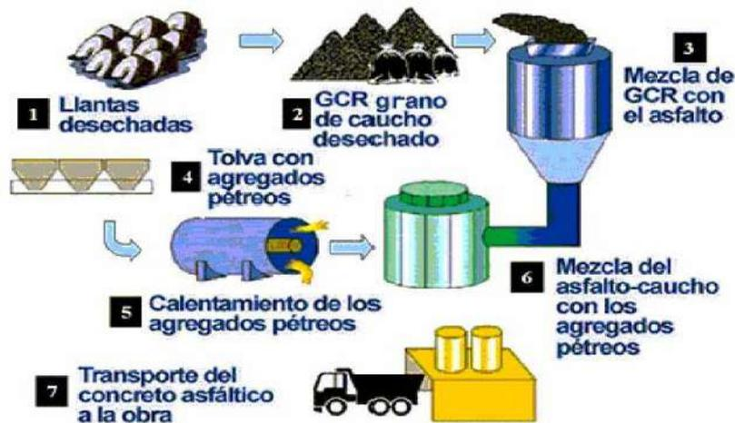
**Figura 9.** Esquema de fabricación de asfalto caucho por vía húmeda.
