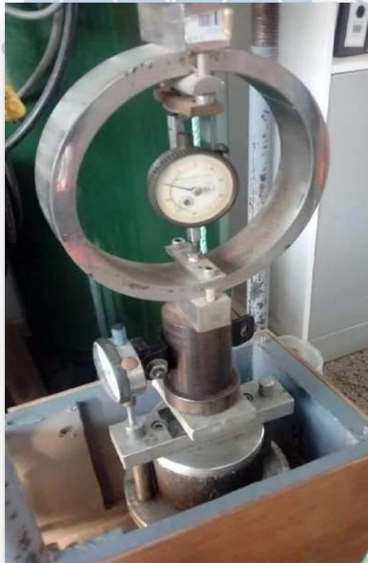
**E.7. Equipo para ensayo de tracción indirecta modificado**
