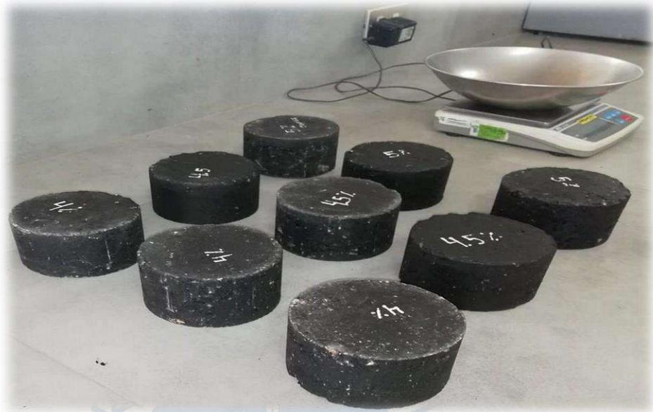
**E.2. Probetas para ensayo Marshall con 1% de caucho**
