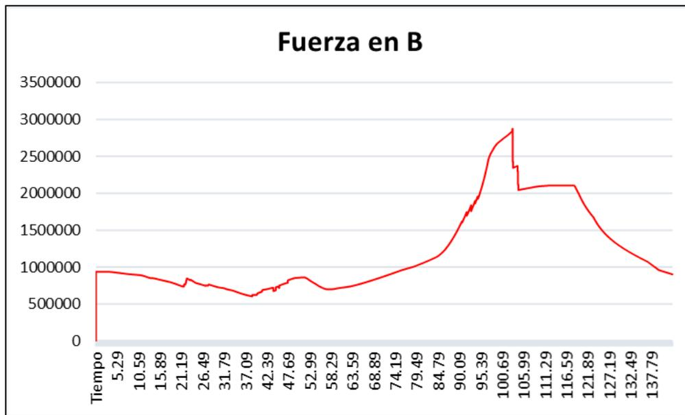
**Figura 53.** Comportamiento de la resultante de la Fuerza en el Pin B.
