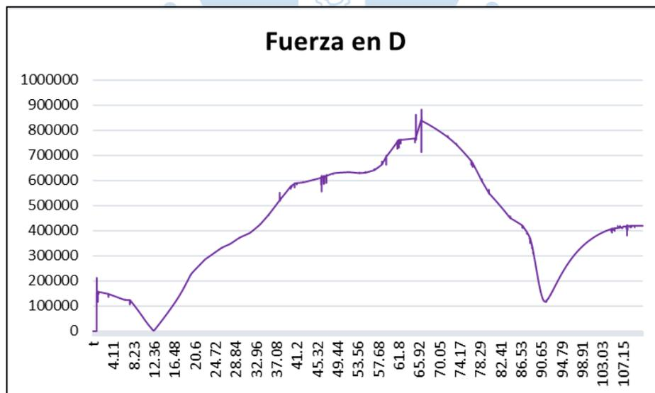
**Figura 47.** Comportamiento de la resultante de la Fuerza en el Pin D.
