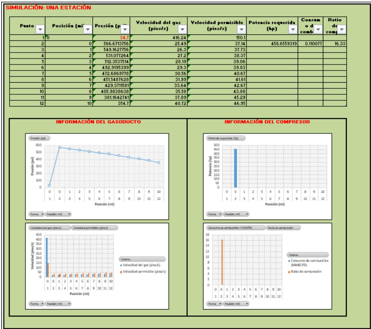
**Ilustración 4-11.** Pantalla de resultados de Simulación.
