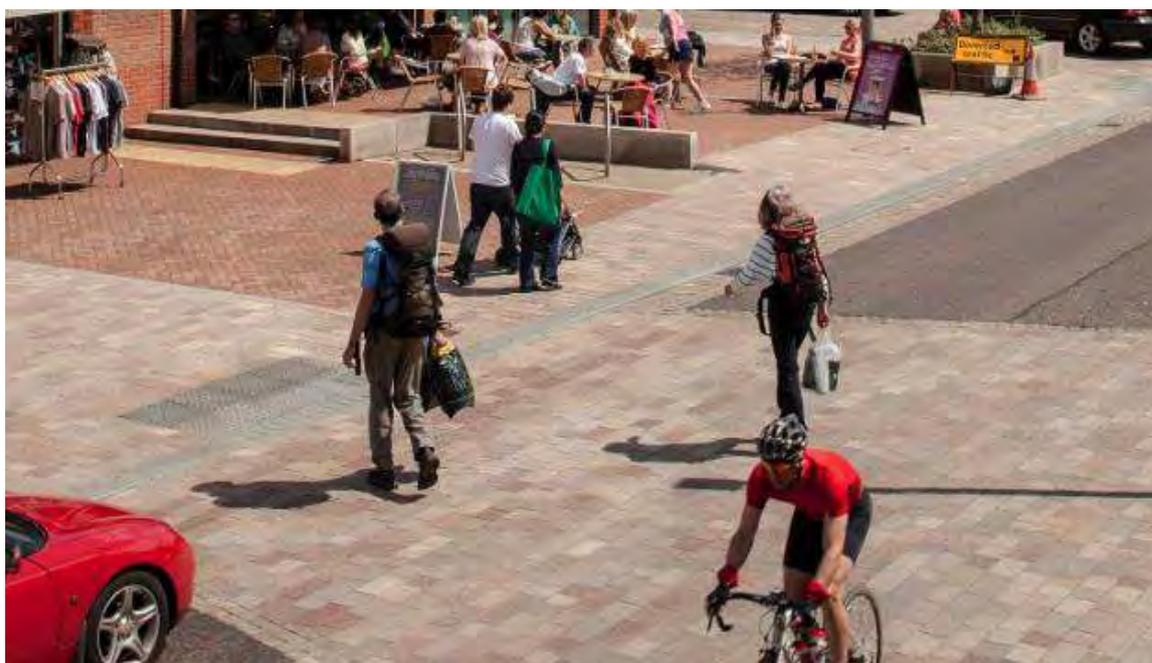
**Figura 21.-** Uso de contraste tonal y superficie texturizada en cruce de cortesía en Poynton.
