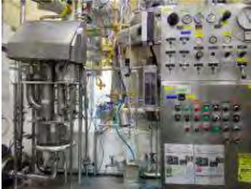
Ilustración 13. Equipo mezclador de bebida o carbocooler.
