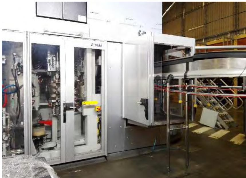
Ilustración 7. Sopladora de botellas PET SB010.
