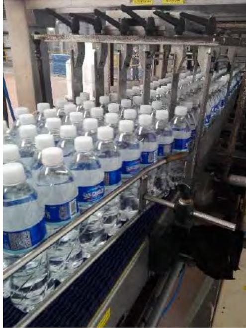
Ilustración 17. Ingreso de botellas a empaquetadora.
